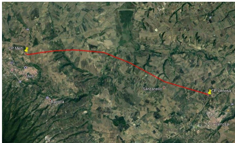
Figura 1 – Cavidotto 150 kV CP Melfi – CP Venosa
