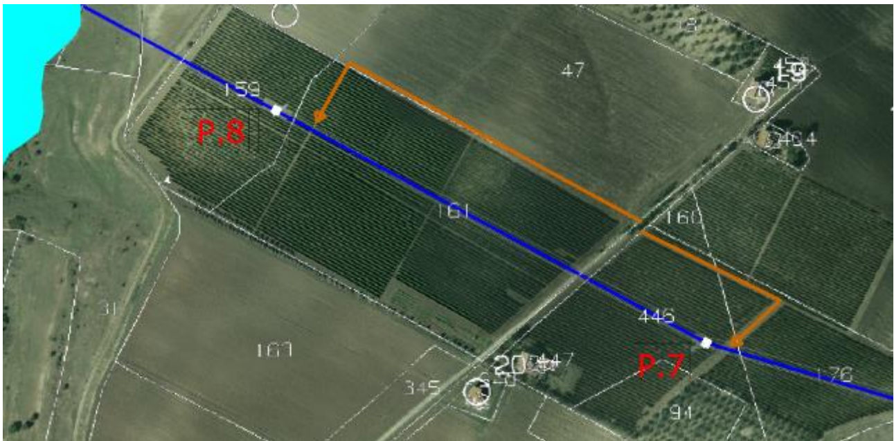
Figura 19 – Accesso tralicci P7 e P8
