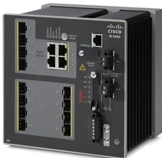
Figura 5 Vista frontale dello switch IE-4000-8S4G-E
