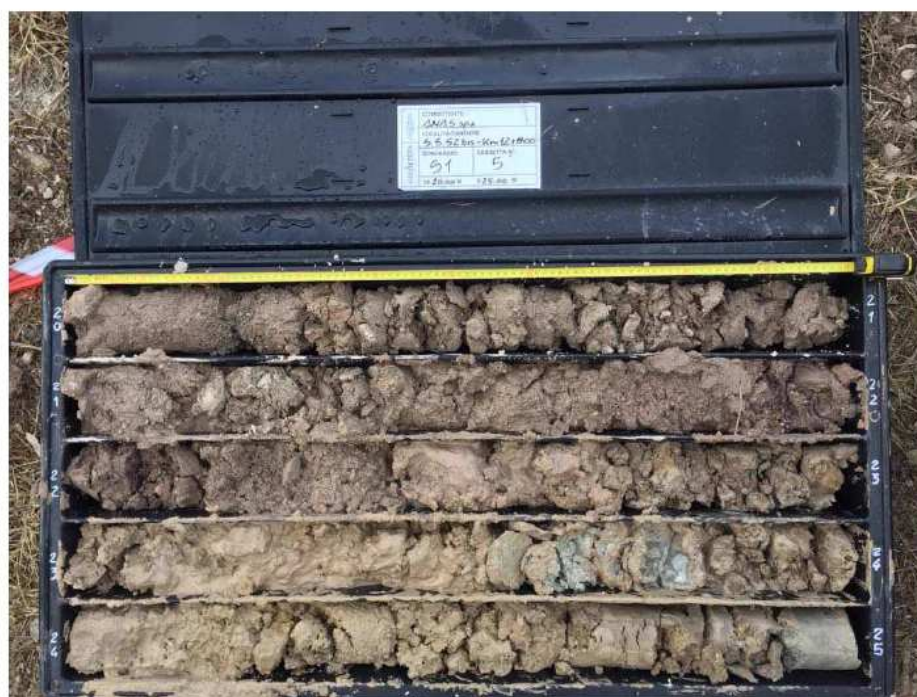
Sondaggio S1: cassetta n° 5, da 20.00 m a 25.00 m.
