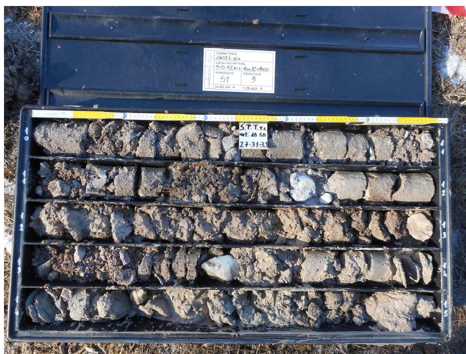
Sondaggio S1: cassetta n° 2, da 5.00 m a 10.00 m.
