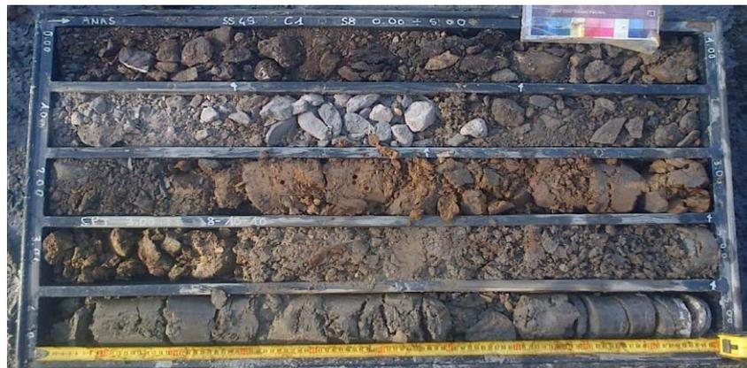
**Figura 56. Depositi antropici (h) ed eluvio-colluviali (e-c) intercettati nel sondaggio S8\_DH tra le profondità di 0-4,8m (cassa n° 1). Si noti la presenza di una significativa componente ghiaiosa nel deposito.**
