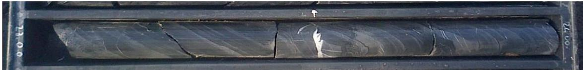
**Figura 46. (In alto) Sondaggio S7\_DH, spezzone di carota (CR3) sottoposto a prova di compressione uniassiale tra le profondità di 7,45÷7,75m. L'orientazione delle superfici di stratificazione forma un angolo esiguo rispetto all'asse della carota. (In basso) Sondaggio S8\_DH, spezzone di carota (CR8) sottoposto a prova di compressione uniassiale tra le profondità di 23,45÷23,7m. L'orientazione delle superfici di stratificazione forma un angolo di circa 45° rispetto all'asse della carota.**
