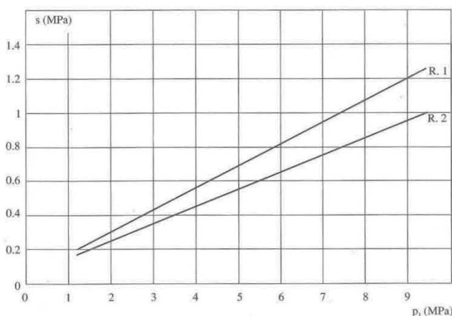
Figura 5 - Diagramma di Bustamante e Doix per rocce
