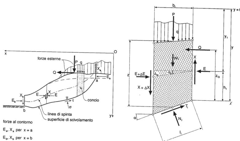
Figura 6 Schematizzazione di calcolo del Metodo delle strisce
