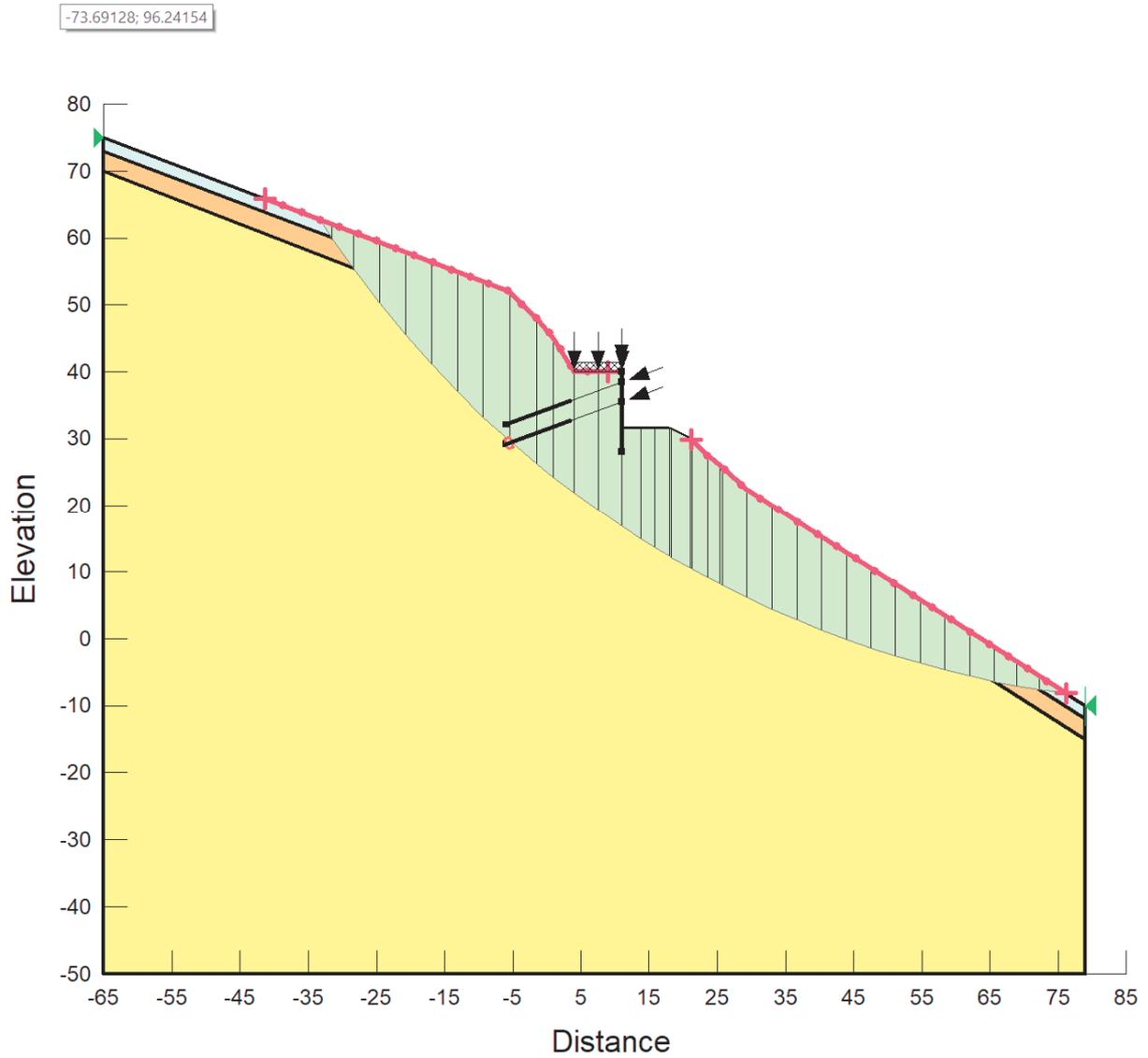
Figura 11 Coefficiente di sicurezza minimo per la stabilità globale in condizioni sismiche (EQK+M2) (+)
