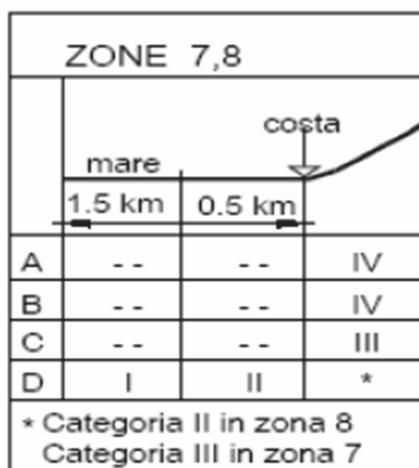
Il coefficiente di topografia  $c_t$  è posto generalmente pari a 1, sia per le zone pianeggianti sia per quelle ondulate, collinose e montane. In questo caso, la figura che segue riporta le leggi di variazione di  $c_e$  per le diverse categorie di esposizione.
