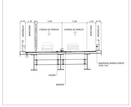
SEZIONE TIPO VIADOTTO - CORRENTE SCALA 1:100
