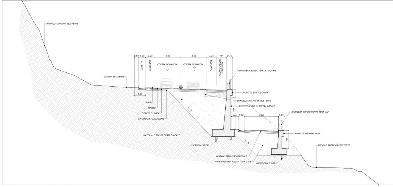
SEZIONE TIPO CON MURO DI SOTTOSCARPA E VIABILITA' PODERALE SCALA 1:100
