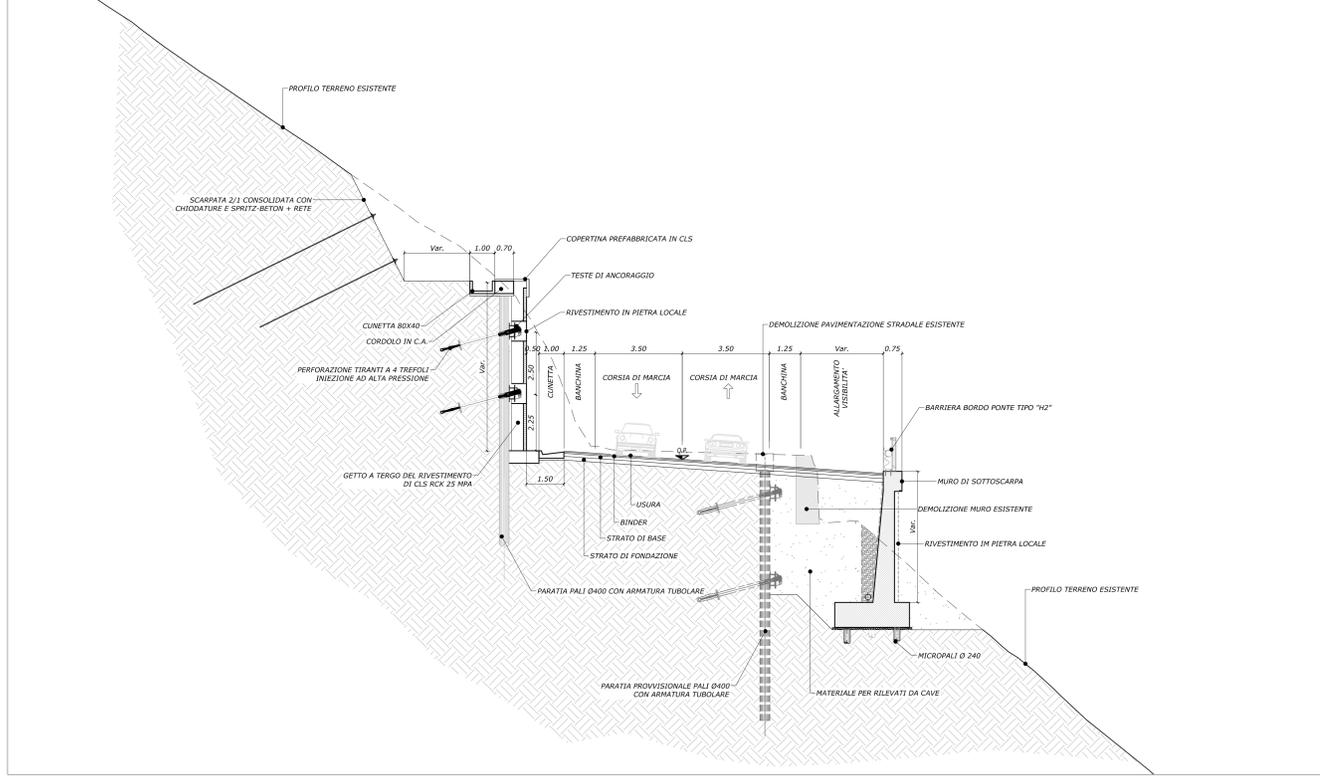
SEZIONE TIPO CON PARATIA DI CONTRORIPA E MURO DI SOTTOSCARPA SCALA 1:100
