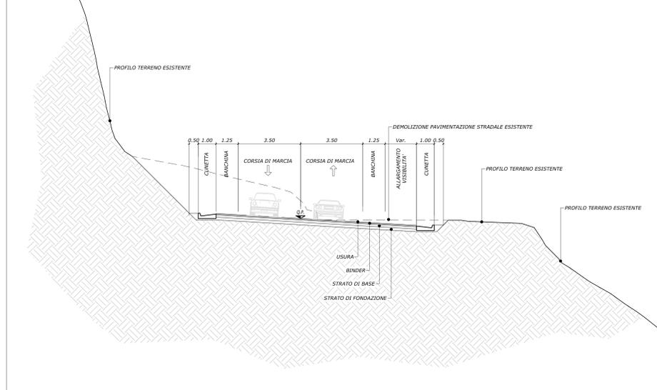
SEZIONE TIPO IN TRINCEA SCALA 1:100
