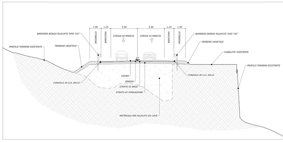
SEZIONE TIPO IN RILEVATO SCALA 1:100
