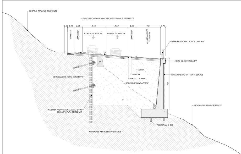
SEZIONE TIPO CON MURO DI SOTTOSCARPA SCALA 1:100
