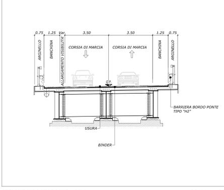
SEZIONE TIPO VIADOTTO - PILA SCALA 1:100
