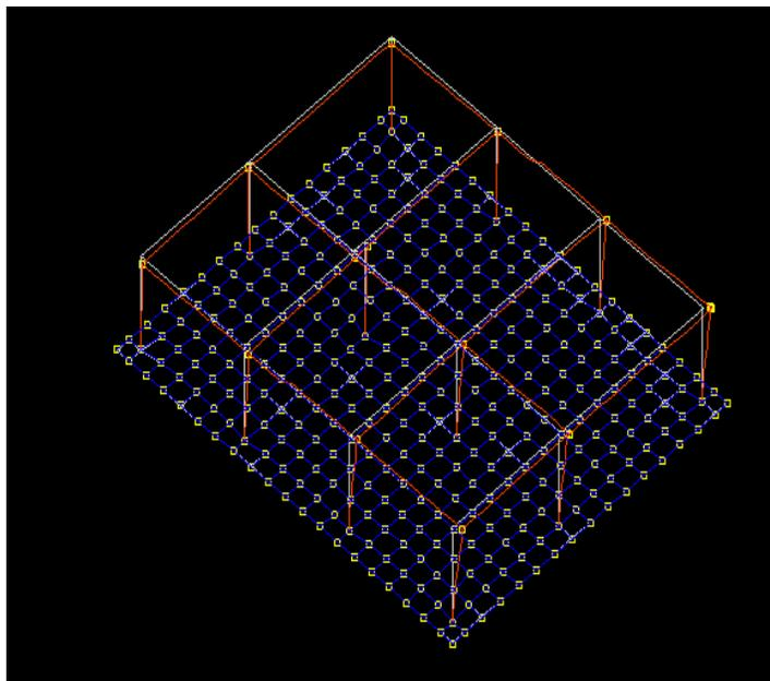
Figura 2 – deformazioni in condizioni SLO sisma X
