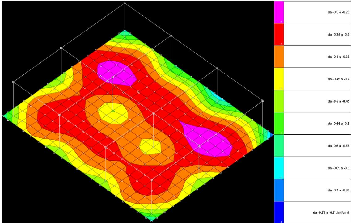
**Figura 7 – pressioni sul terreno (massime)**
