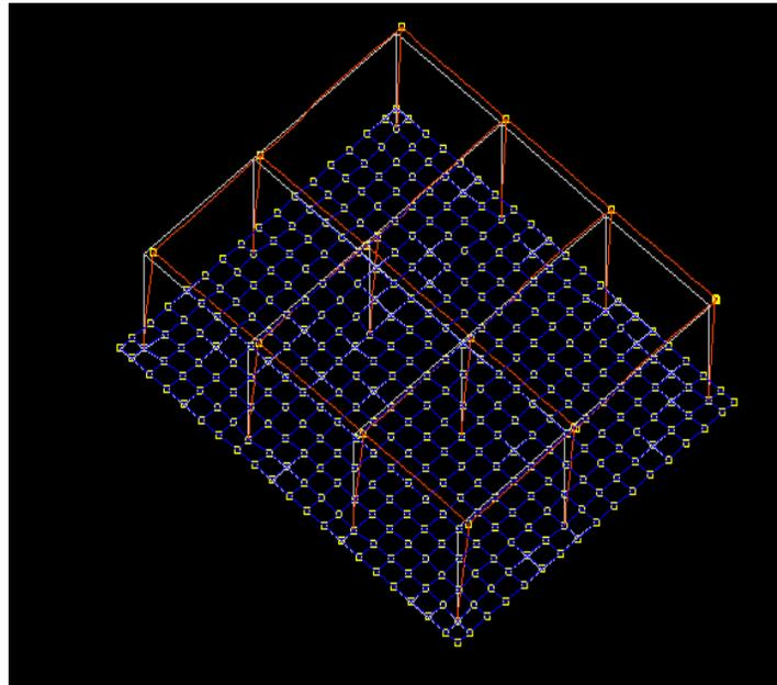
Figura 3 – deformazioni in condizioni SLO sisma Y
