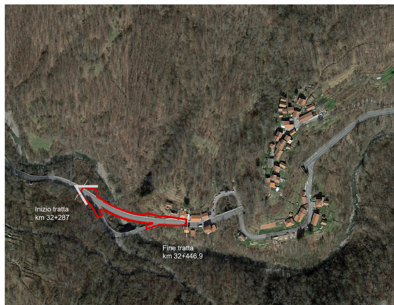
Ortofoto con simulazione SS45 di progetto tra le progressive chilometriche 32+287 e 32+446,9 - scala 1:3500
