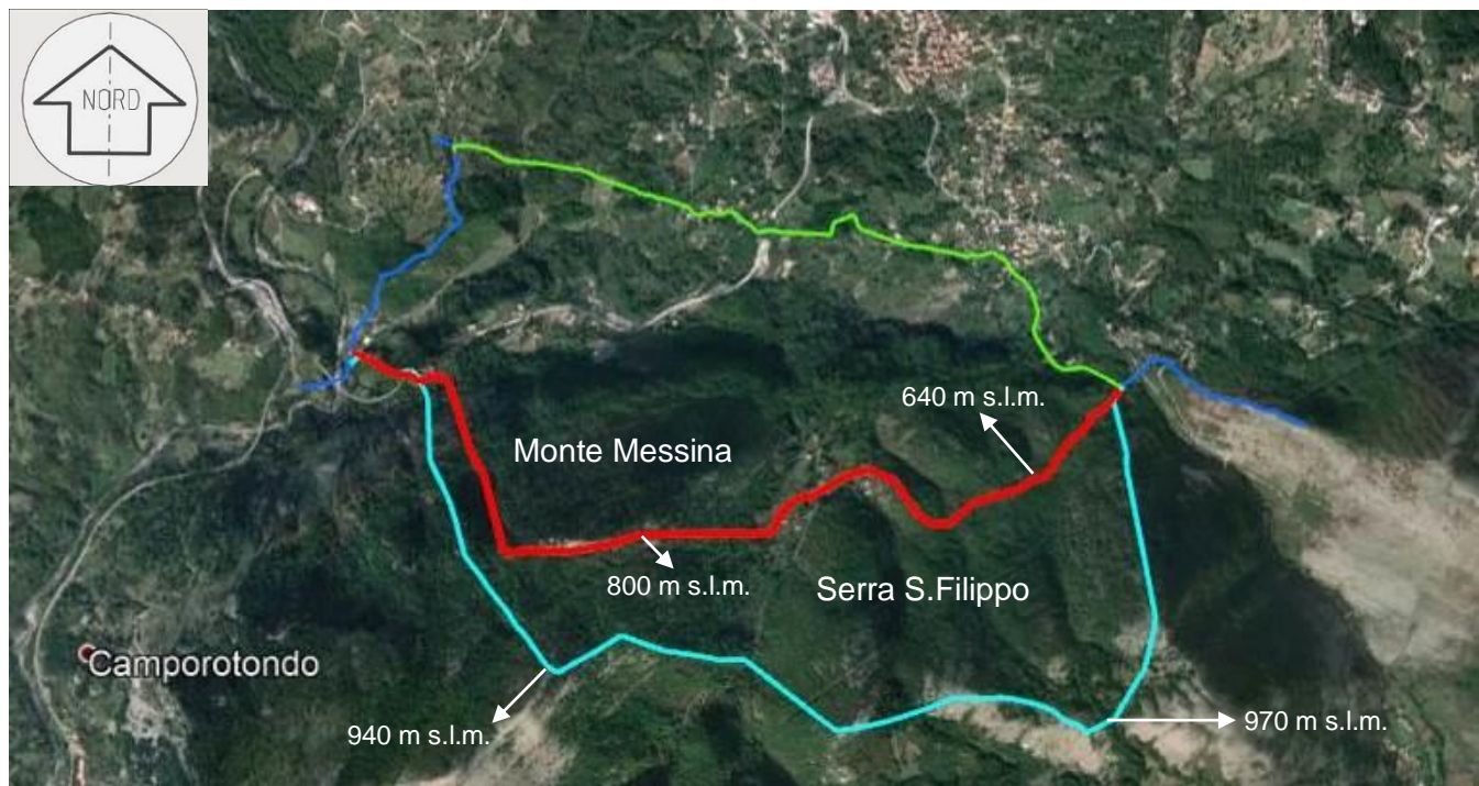
Fig. 4 - Vista aerea con ubicazione dell'opera in progetto (linea rossa), della direttrice di partenza (linea azzurra) e del metanodotto esistente (linea verde)
