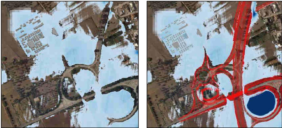
Figura 37: Confronto Simulazione stato attuale e stato di progetto TR200 anni - Zona Cimitero di Nociglia
