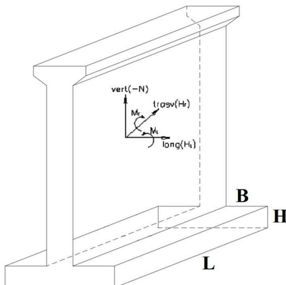
Figura 3 - Schema pila e convenzione dei segni
