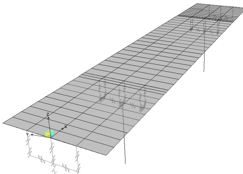
Figura 5-2: Modello di calcolo: con elementi shell soletta in vista
