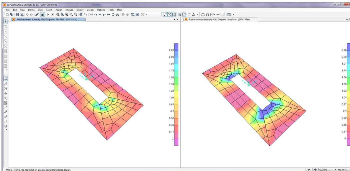
Figura 11-11 – Richiesta di armatura: Ast1\_SX e Ast2\_DX
