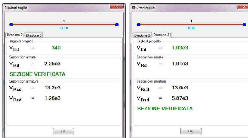
Figura 11-2 – Pila 1: Dettaglio verifiche a taglio (V<sub>2</sub> e V<sub>3</sub>) (unità di misura: kN; m; °C)
