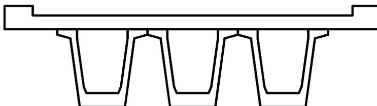
La trave è del tipo a cassone precompresso a fili aderenti e presenta due tipi di sezione: una sezione corrente di tipo A e una sezione ringrossata tipo B in corrispondenza degli appoggi per una lunghezza di 1m. La zona di raccordo tra le due sezioni misura una lunghezza di 1m.
