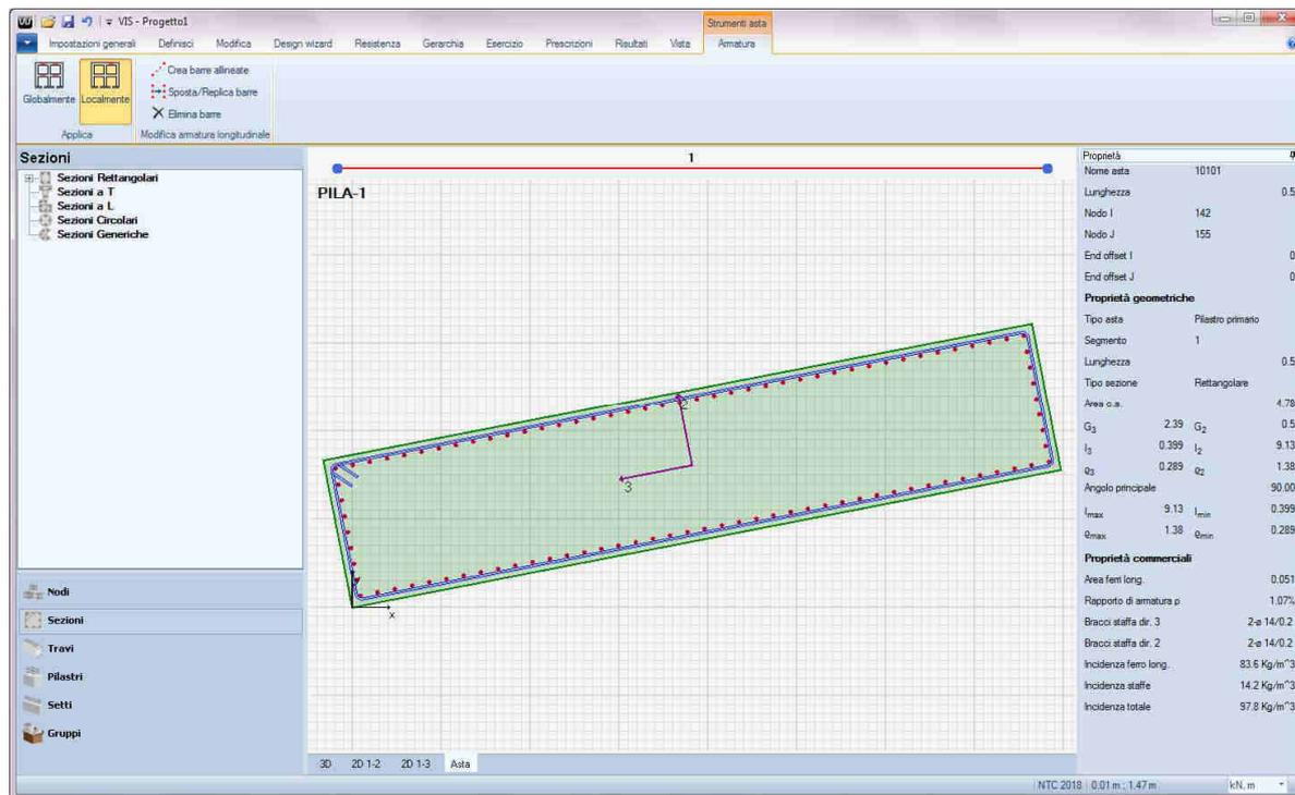
Figura 10-1 – Pila 1: sezione di verifica 4.78 x 1.00 –  $\phi 26/10$
