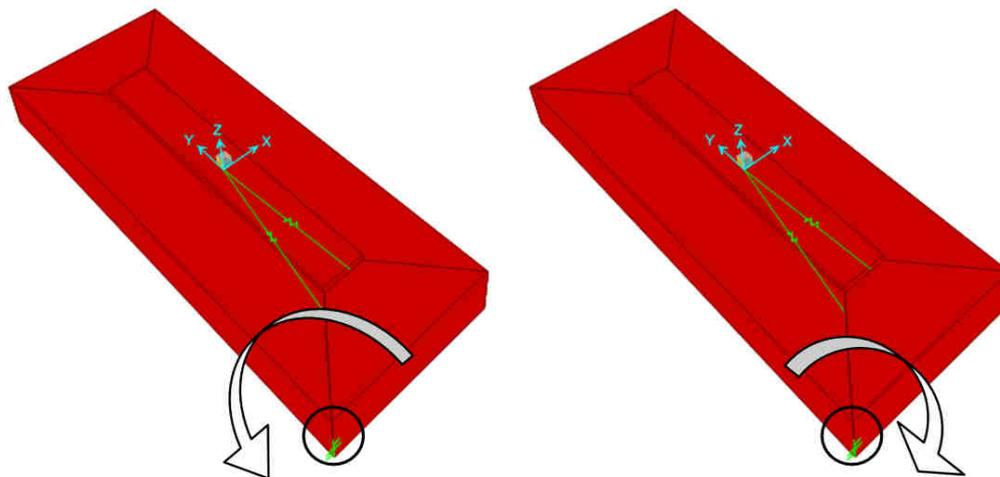
Figura 11-12 – Zattera di fondazione: cinematico di ribaltamento
