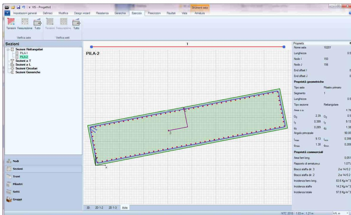
Figura 11-1 – Pila 2: sezione di verifica 4.78 x 1.00 –  $\phi$ 26/10
