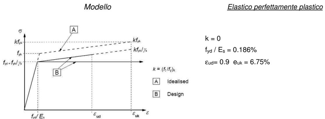
Per i calcoli agli stati limite d'esercizio (SLE) a "tempo infinito", si considera un coefficiente di omogeneizzazione per l'acciaio n=15.
