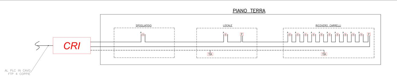
RILEVATORE DI FUMO A SOFFITTO SCHEMA DI COLLEGAMENTO
