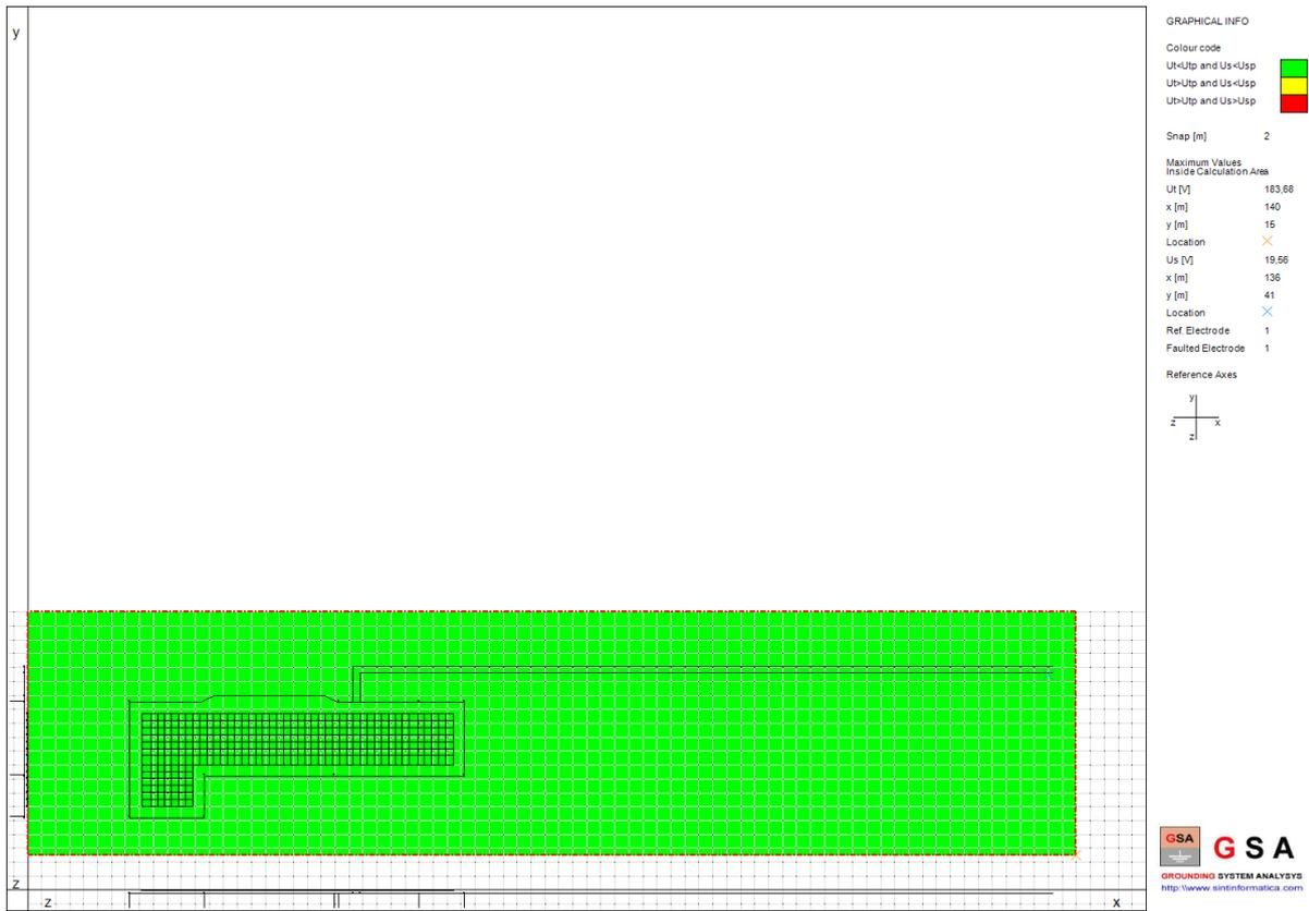
Figura 9 - Confronto tra tensioni di contatto e di passo ed i relativi limiti ammessi
