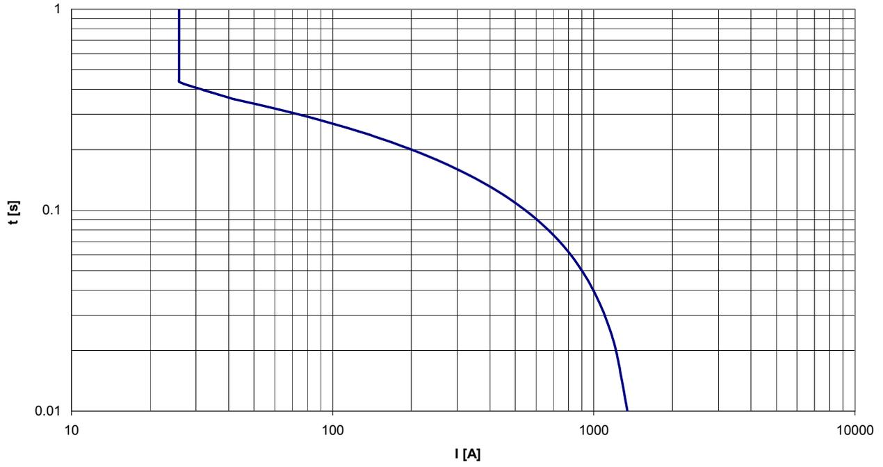
**Figura 5 - Corrente di inrush trasformatori derivati dalla dorsale**
