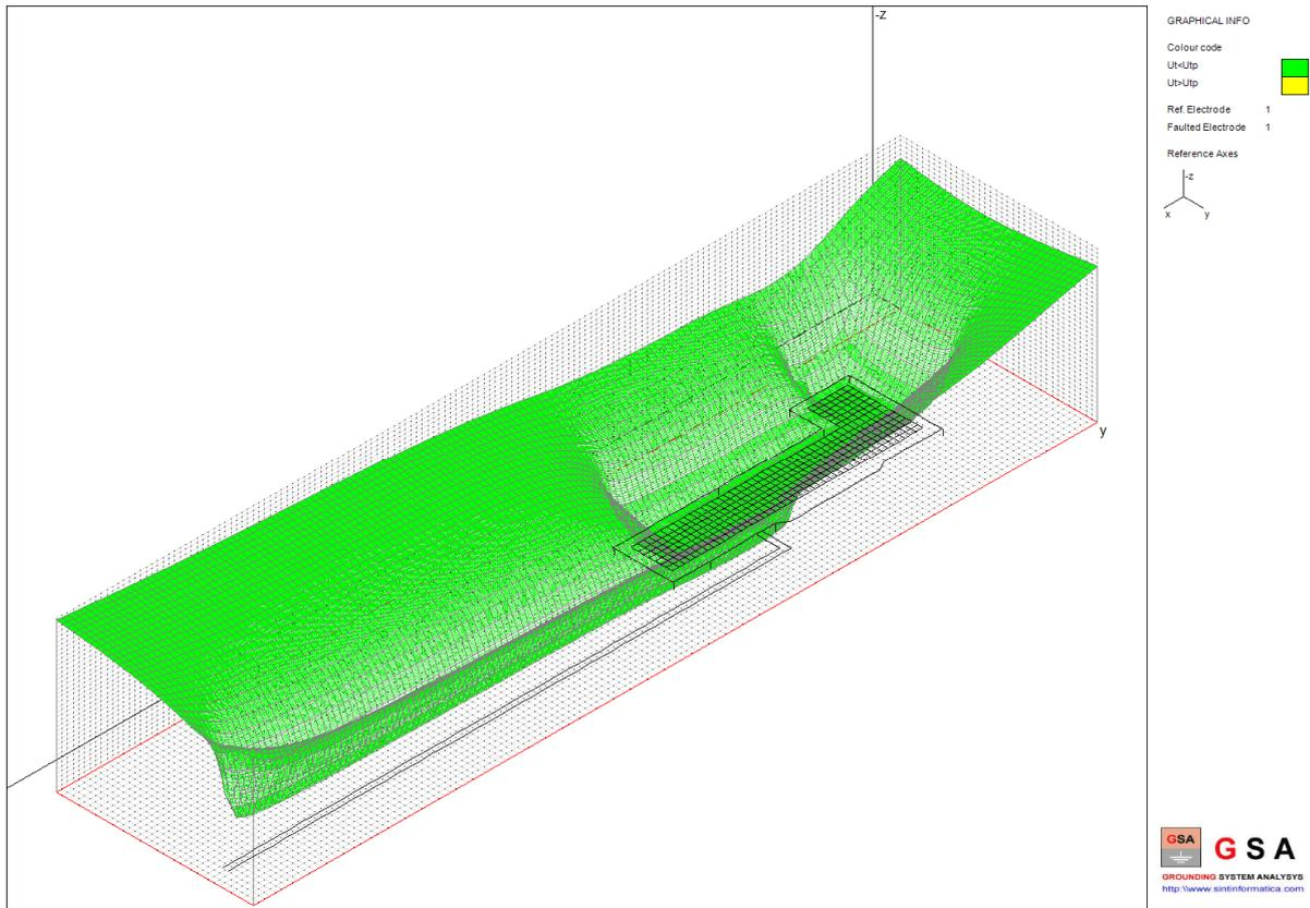
Figura 10 - Distribuzione delle tensioni di contatto e confronto con i limiti ammessi (rapp. 3D)
