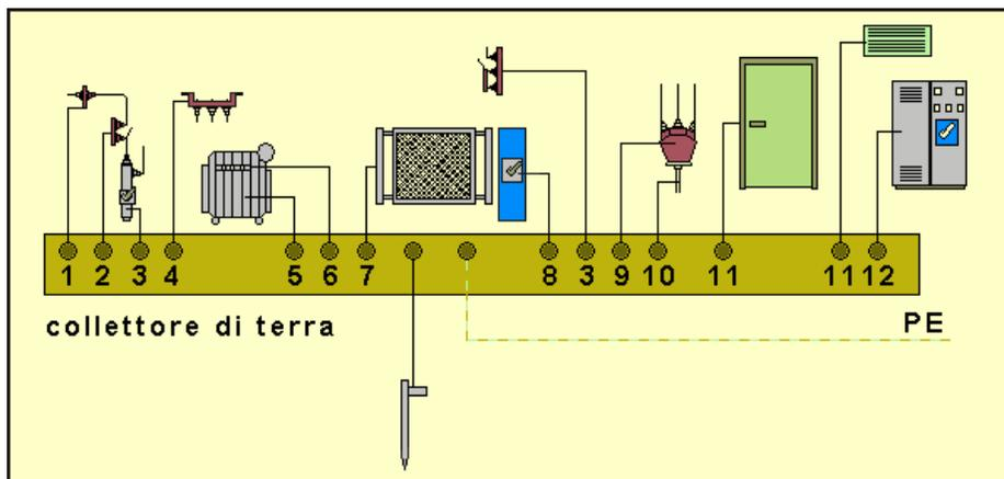
**Figura 2 – Esempi di collegamenti a terra in cabina**
