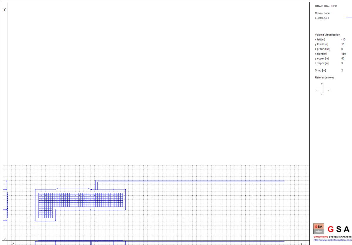
Figura 6 - Modello dispersore di cabina
