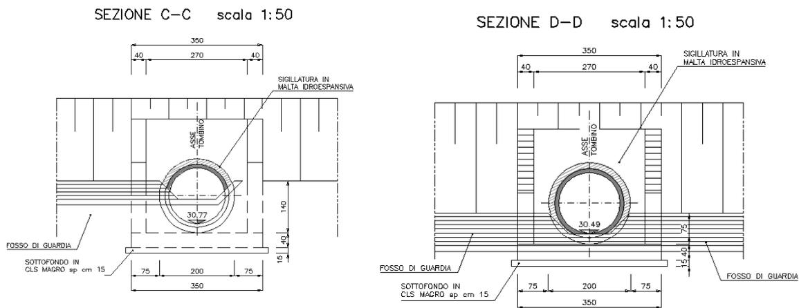
L’elaborazione dei calcoli statici e le verifiche di stabilità, in ottemperanza al metodo degli stati limite, sono state condotte con l’ausilio del programma di calcolo “*SCATI4.0*” prodotto da *Aztec informatica*, considerando un’altezza interna di 2,80 m.
