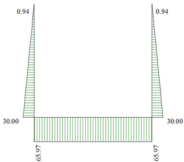
Figura 6 - Diagramma involuppo sforzo normale - SLE
