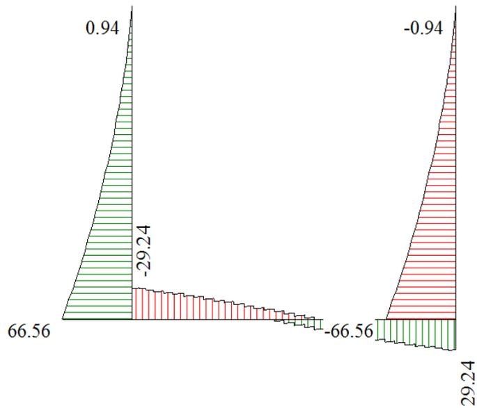
**Figura 4 - Diagramma involuppo taglio – SLE**
