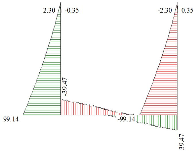
**Figura 3 - Diagramma involuppo taglio – SLU**
