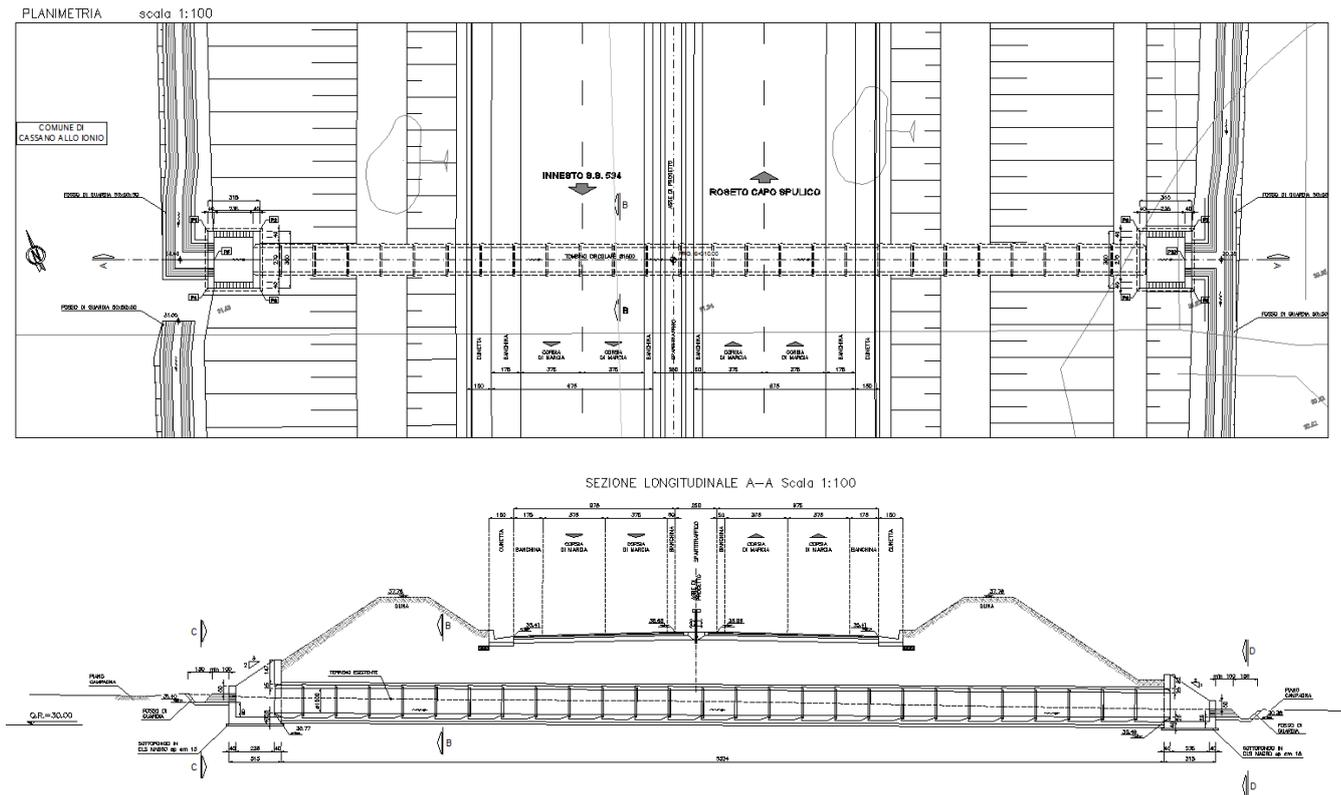
Si tratta di una struttura costituita dall'insieme di moduli circolari in cemento vibrocompresso armato di diametro interno pari a 1500 mm e manufatti gettati in opera di imbocco e di uscita.
