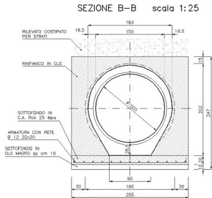
La sezione trasversale del manufatto di imbocco è costituita da una struttura scatolare sulla quale poggia il fosso di guardia per non ostacolare lo scorrimento longitudinale delle acque.
