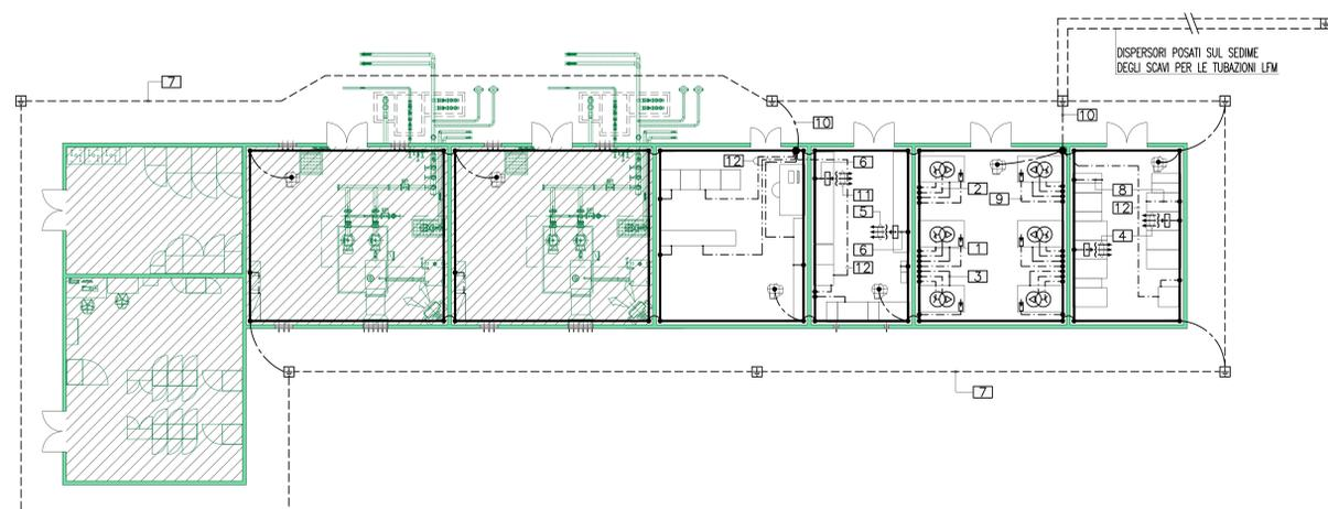
DISPOSIZIONE DELLE APPARECCHIATURE ED IMPIANTI DI CONDIZIONAMENTO E VENTILAZIONE
