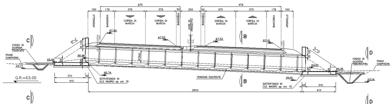
Si tratta di una struttura costituita dall'insieme di moduli circolari in cemento vibrocompresso armato di diametro interno pari a 1500 mm e manufatti gettati in opera di imbocco e di uscita.
