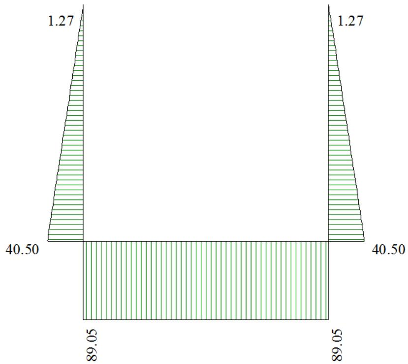
**Figura 5 - Diagramma involuppo sforzo normale – SLU**
