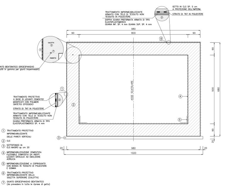
SEZIONE TIPO E-E CANALE IN CLS scala 1:100
