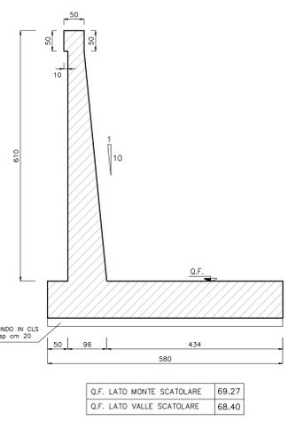
SEZIONE MURO (G-G) scala 1:50
