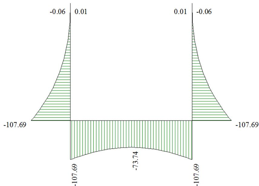
Figura 1 - Diagramma involuppo momento flettente – SLU
