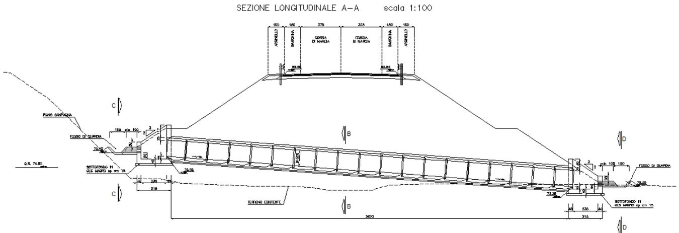
Si tratta di una struttura costituita dall'insieme di moduli circolari in cemento vibrocompresso armato di diametro interno pari a 1500 mm e manufatti gettati in opera di imbocco e di uscita.
