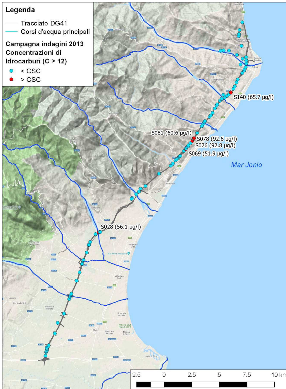
Figura 11. Ubicazione dei campioni di terreno della campagna 2013, caratterizzati da valori di concentrazione degli Idrocarburi C>12 superiori alla CSC
