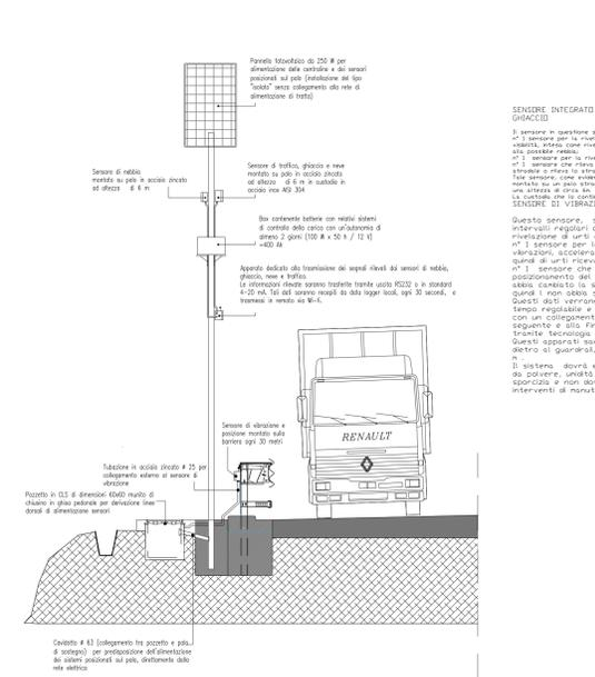
**MARGINE IN RILEVATO SEZIONE CORRENTE - Scala 1:25**
