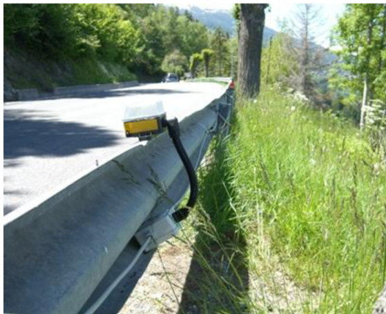
Figura 8 Contenitore morsettiera per collegamenti elettrici GRAPE/WEDGc (versione cablata)
