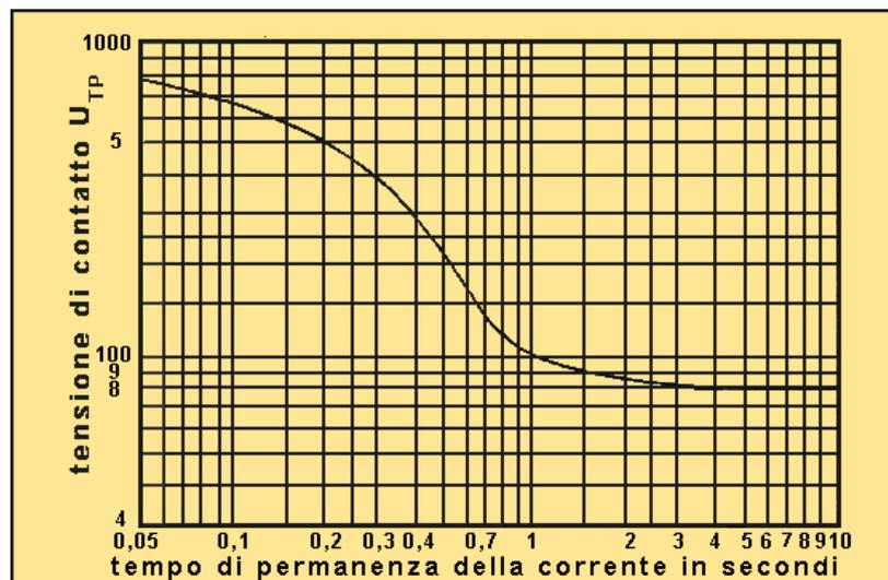
Fig.14.13 – Tensioni di contatto ammissibili U<sub>TP</sub> (UC per la vecchia norma) per correnti di durata limitata.
