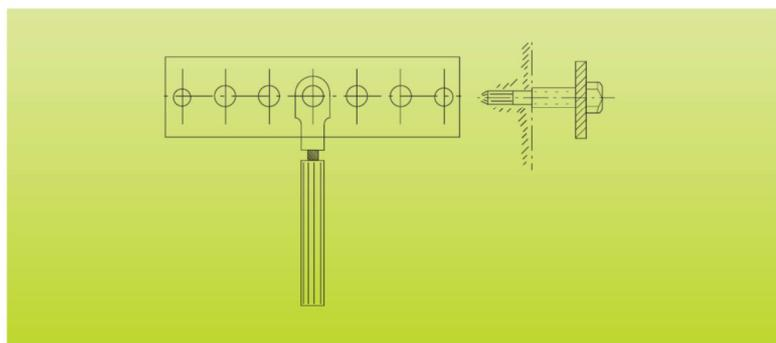
Fig. 8/4 - Esempio di collettore principale di terra
