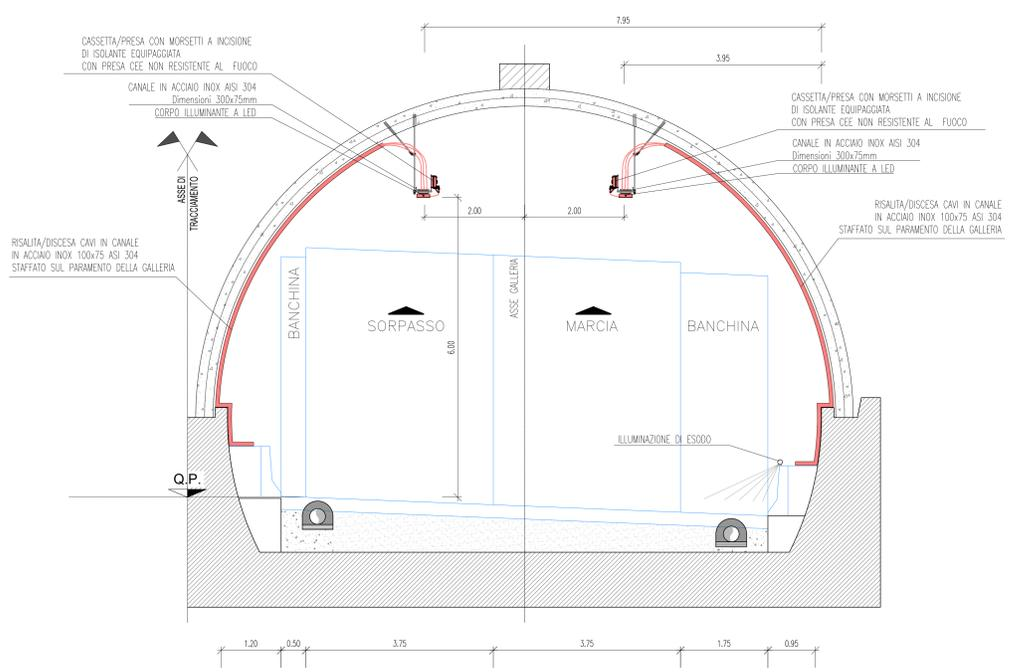
DETTAGLIO SISTEMA DI ANCORAGGIO CANALINE IN VOLTA
