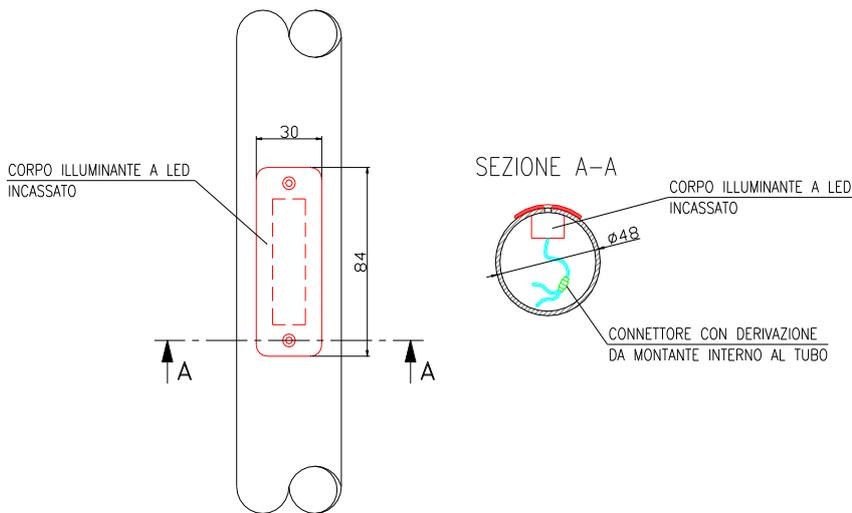
Tale sistema d'illuminazione sarà in grado di assicurare un illuminamento medio di 5 lux, con un minimo di 2 lux, su una fascia a terra che dovrà iniziare ad una distanza di 20÷40cm dal paramento della galleria, e di larghezza pari a 90cm minimo, come previsto dalle
