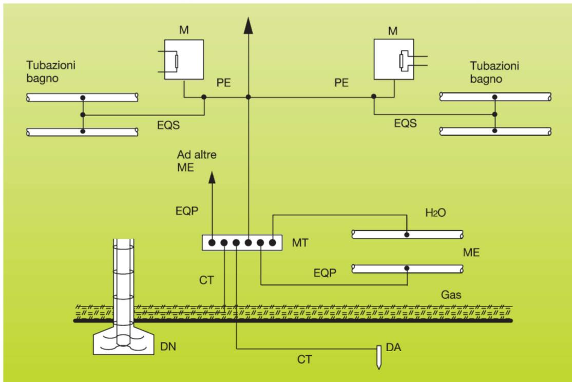
Genericamente esso sarà realizzato con una serie di dispersori in acciaio zincato a caldo, infissi nel terreno, e con un cavo (conduttore di terra) per il collegamento tra l'impianto disperdente ed il collettore di terra. Il dettaglio della distribuzione dell'impianto di terra è prodotto nel disegno allegato: lo scopo finale è quello di costruire un efficiente sistema di dispersione tutto intorno al complesso.
