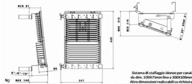
Sistema di staffaggio idoneo per canale da dim. 100x75mm fino a 300x100mm. Altre dimensioni realizzabili su richiesta.
