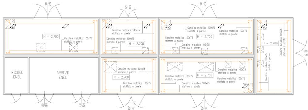
Planimetria con disposizione canali metallici e tubazioni
