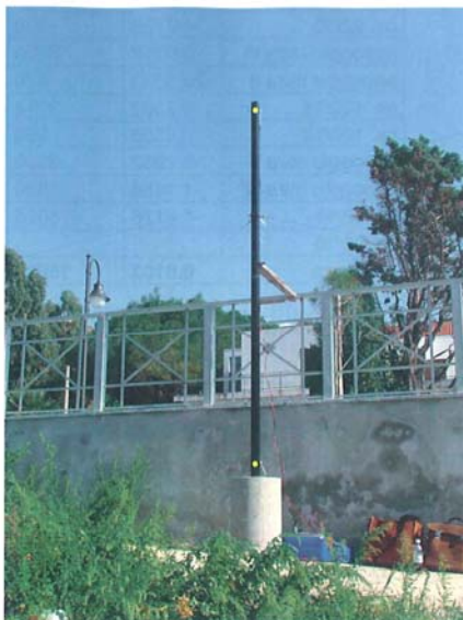
Fig. 3 – Mira speciale posta in posizione verticale su apposito pilastro.
