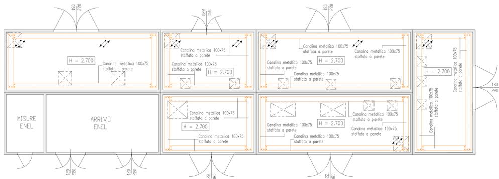
Planimetria con disposizione canali metallici e tubazioni
