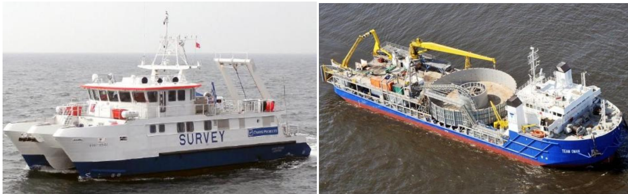
Figura 4.6 – A sinistra: imbarcazione per il rilievo geofisico e BOB; a destra: nave per l'installazione dei cavi
