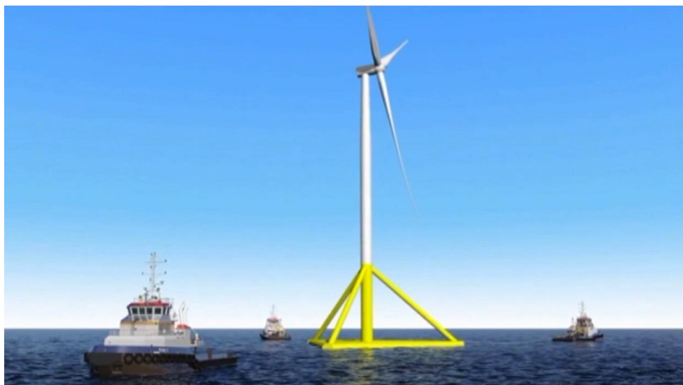
Figura 4.3 – Riproduzione grafica dell'operazione di rimorchio della turbina eolica su piattaforma galleggiante
