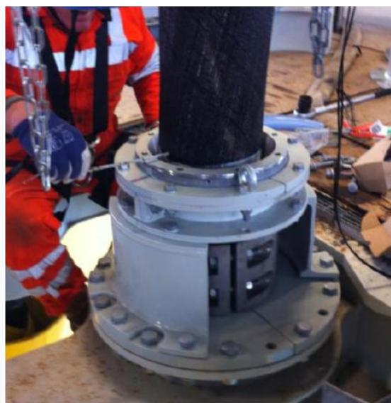
Figura 4.5 – Vista di una valvola di aggancio hang-off
