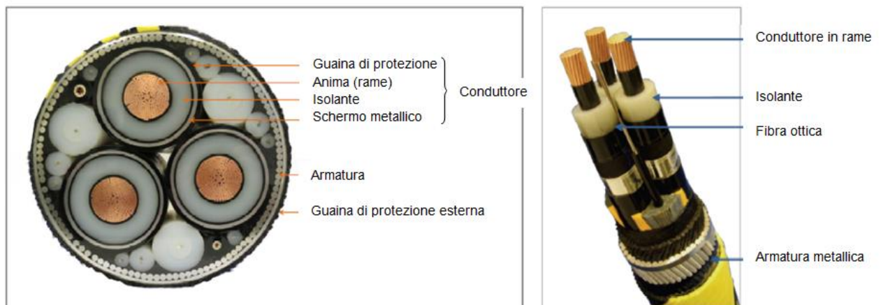
Figura 3.5 – Cavo di connessione elettrica tra le turbine (Fonte: a sinistra, NSW ; a destra, Draka)
