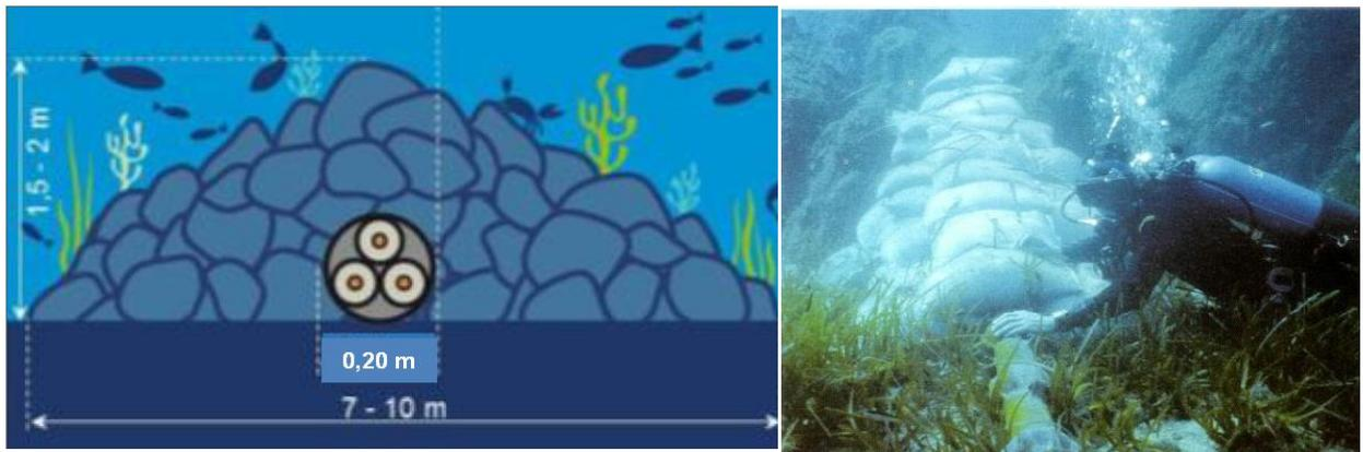
*Figura 4.11 - Esempio di cavi posati sul fondale e sistema di protezione dei cavi*
