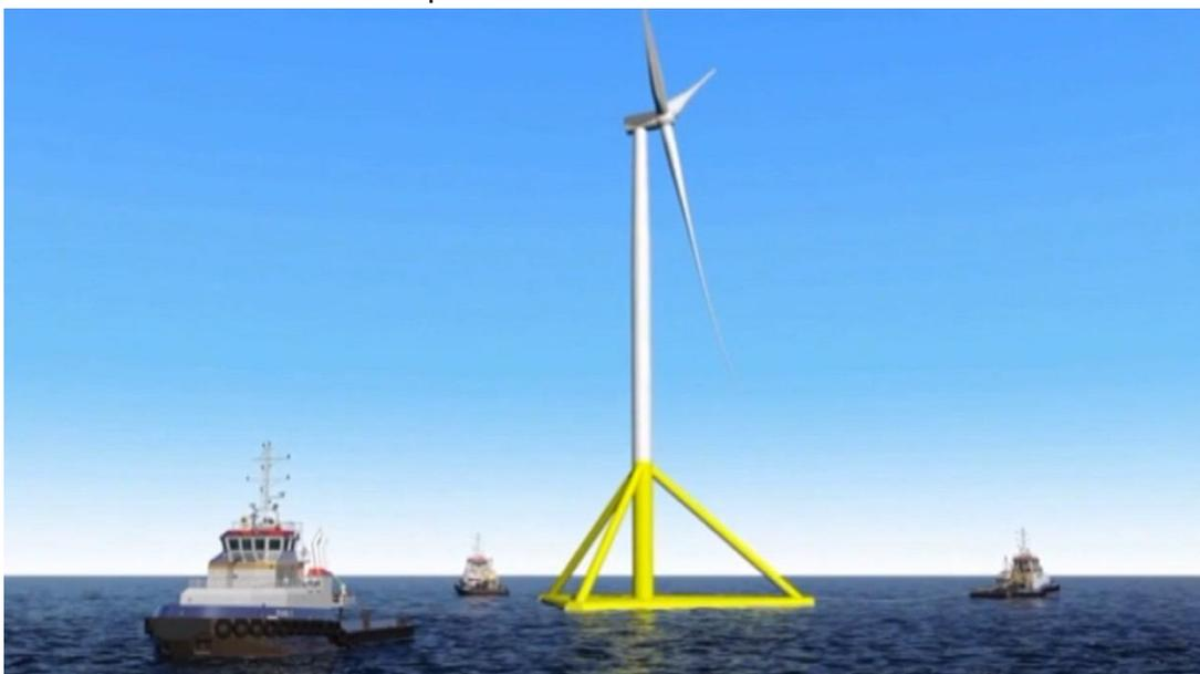
*Figura 4.15 - Riproduzione grafica dell'operazione di rimorchio della turbina eolica su piattaforma galleggiante*
