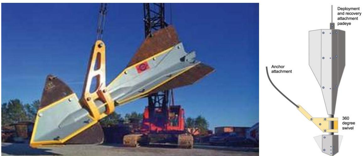
Figura 3.4 – Illustrazione di ancora a gravità con infissione dinamica
