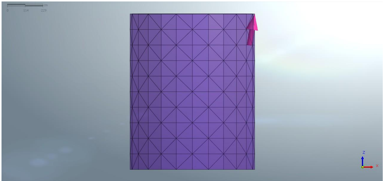
Figura 3.7 – Simulazione FEM di ancora Suction Bucket
