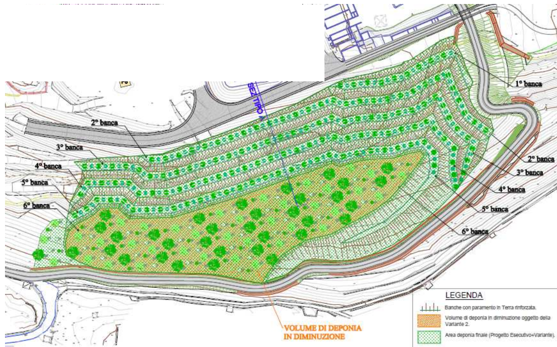
Figura 5 – Planimetria di ripristino del sito di deposito.
