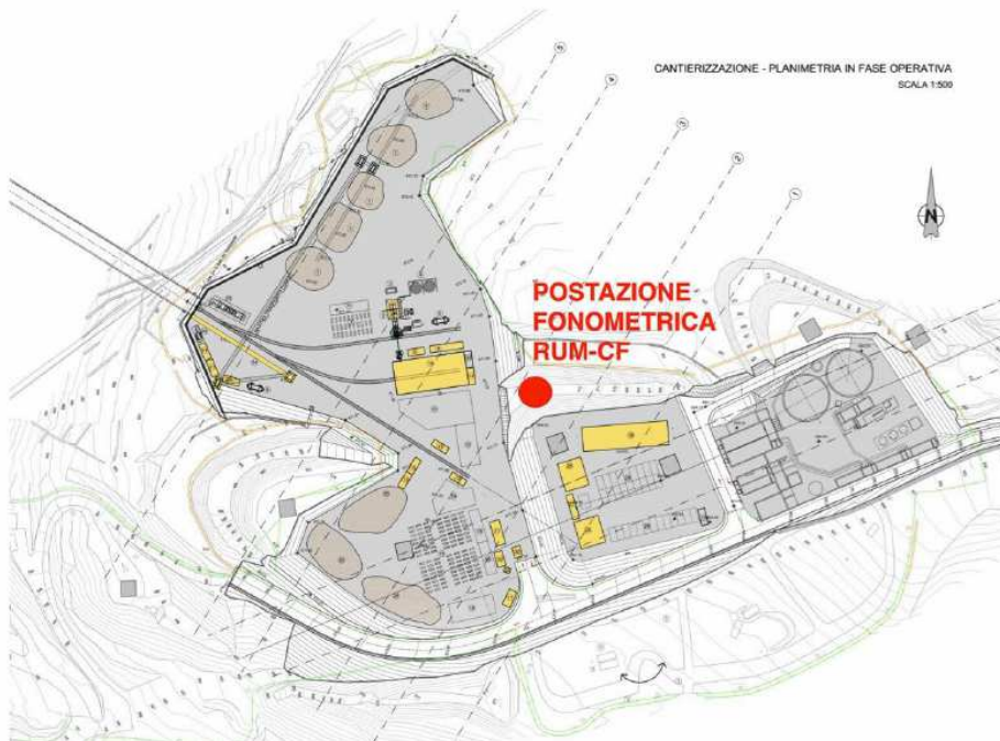
Figura 12 – Localizzazione della postazione fissa (RUM-CF) per il monitoraggio del rumore ambientale in continuo. La postazione discontinua (RUM-DS) verrà dislocata all'interno dell'area del cantiere in funzione dei macchinari utilizzati.
