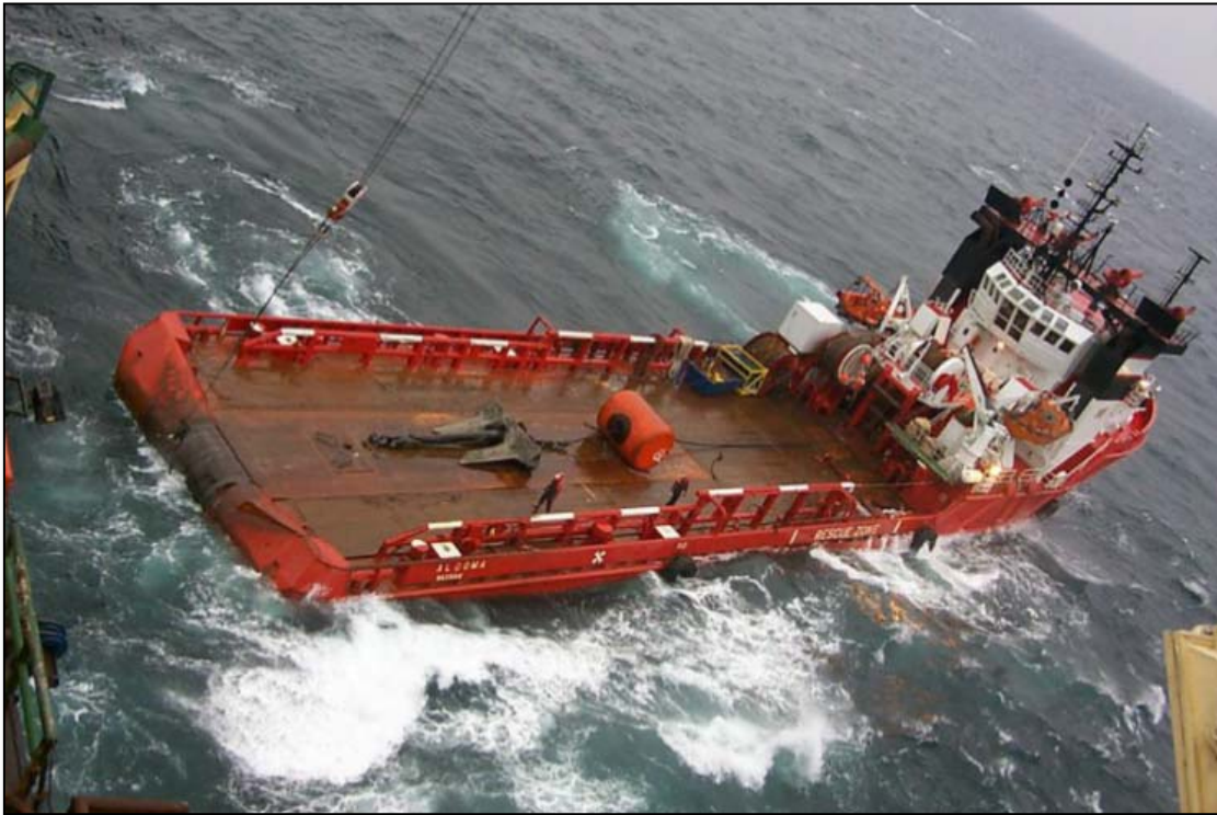
Fig. 2 – Tipico Rimorchiatore utilizzato per la movimentazione ancore.
