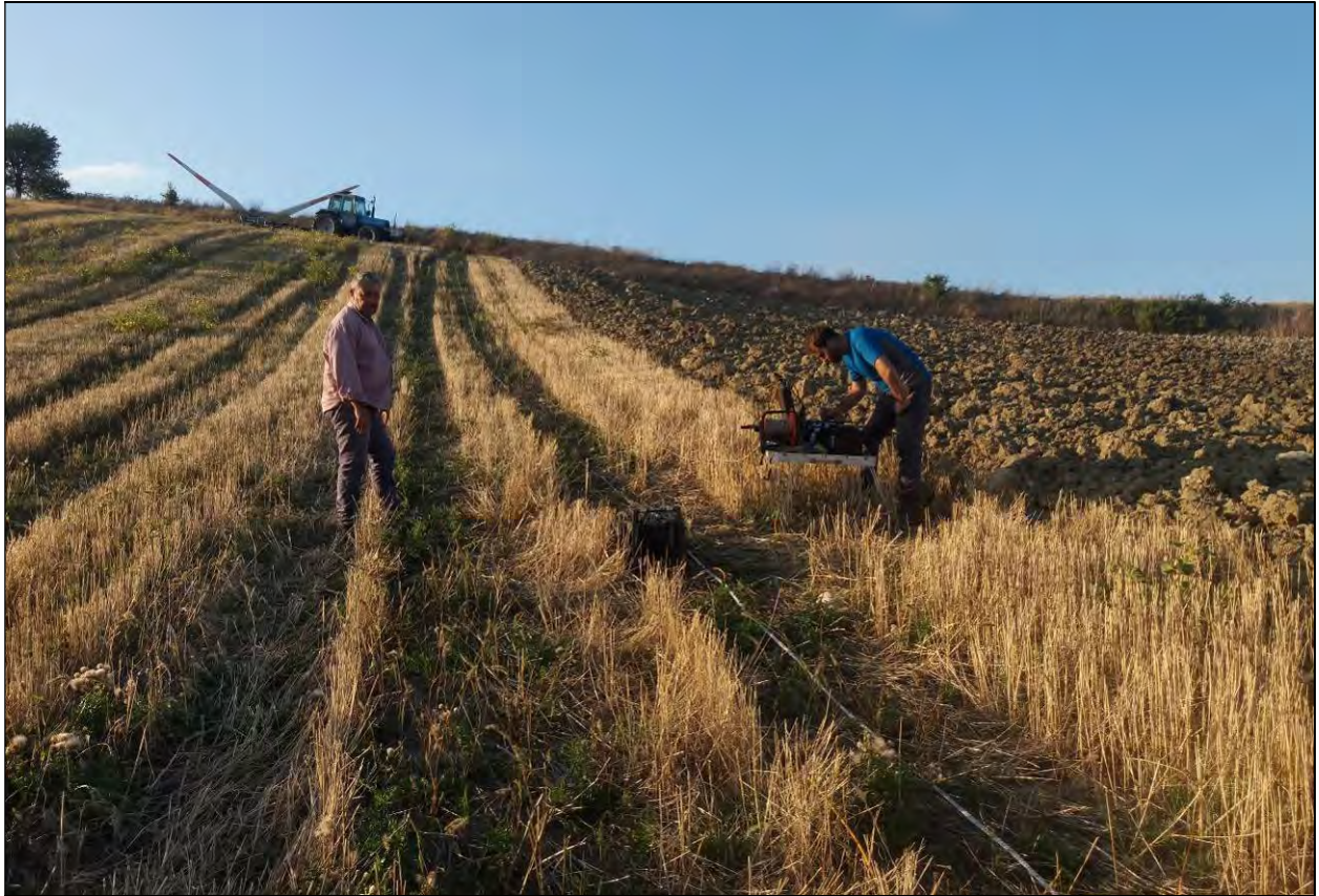
Foto 11: prova sismica a rifrazione R1 (2019) presso l'aerogeneratore WTG 16
