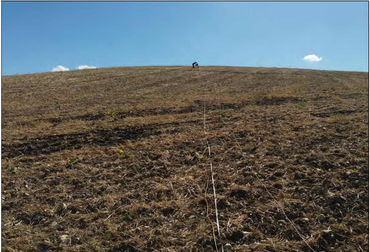
Foto 13: prova sismica a rifrazione R3 (2019) perpendicolare al tratto iniziale della strada esistente d'accesso a WTG 7-9-16
