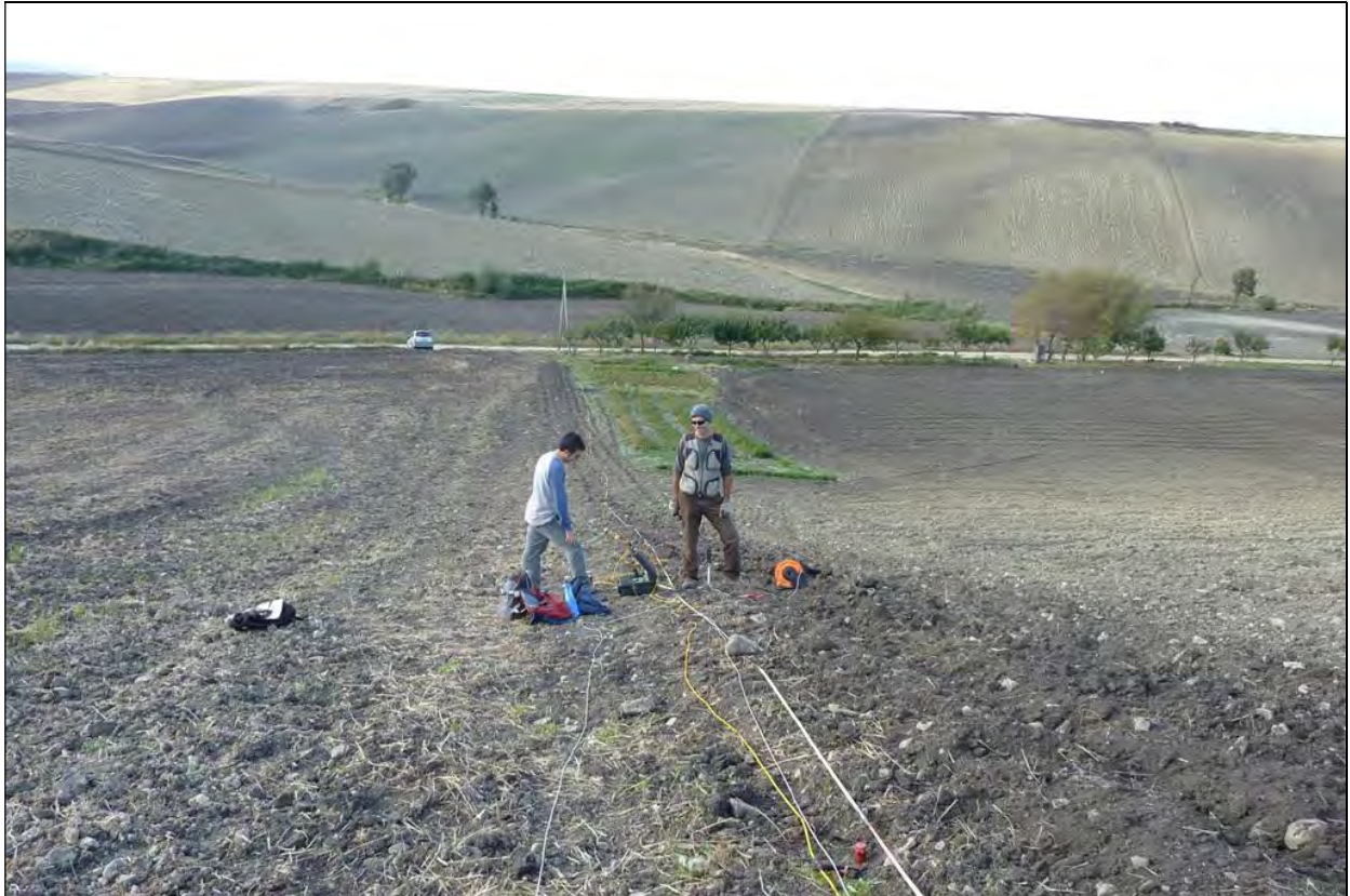
Foto 9: prova sismica a rifrazione WTG/7 (2010) presso l'aerogeneratore WTG 7
