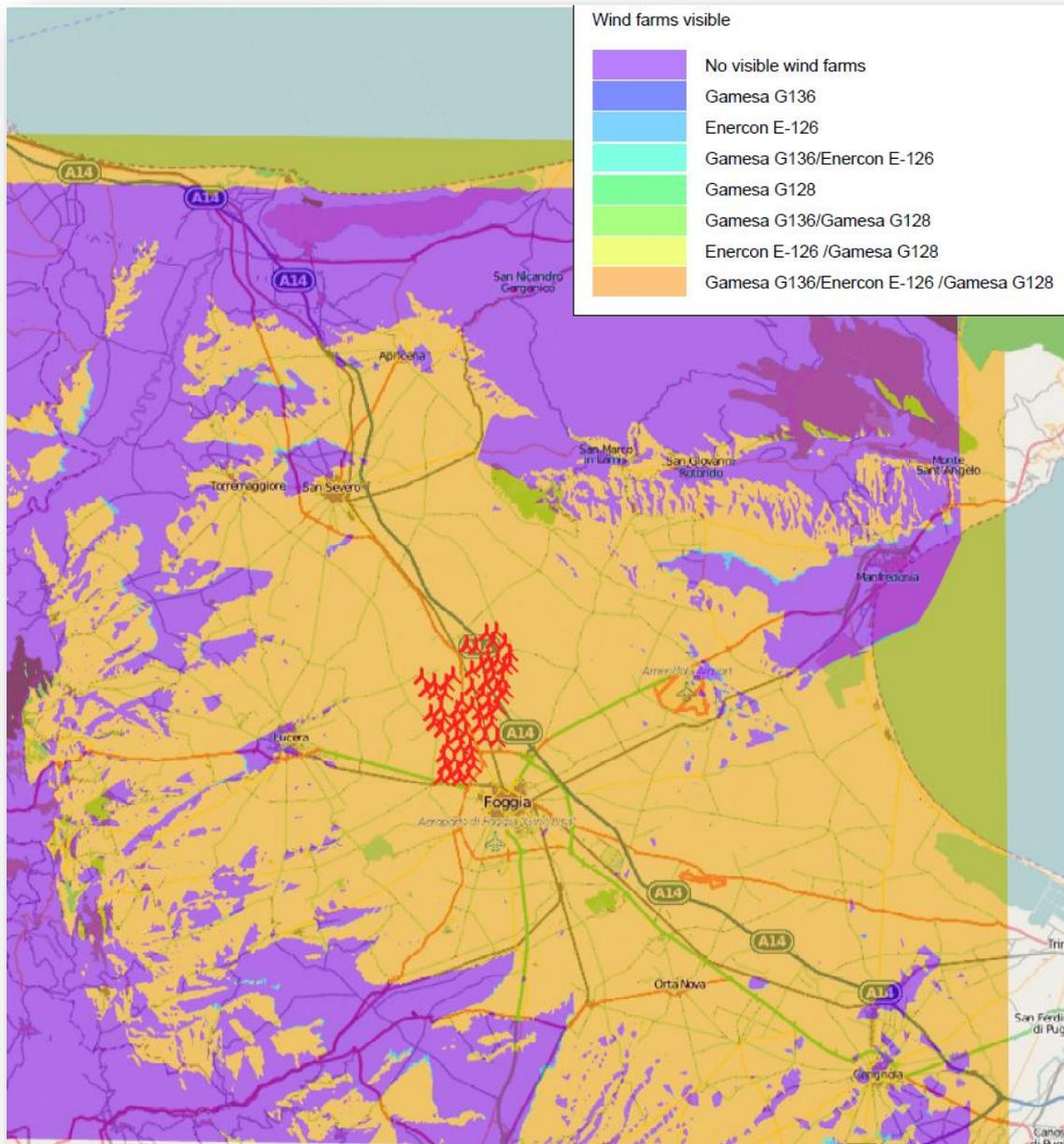
Fig. 87 –Impatto al variare dell’aerogeneratore – WindPro
