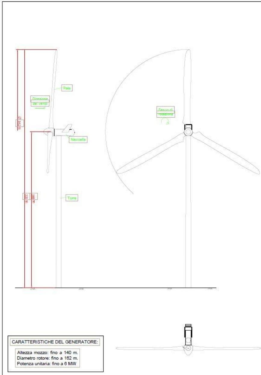
Fig. 74 – Caratteristiche aerogeneratore Vestas V162-5.6MW
