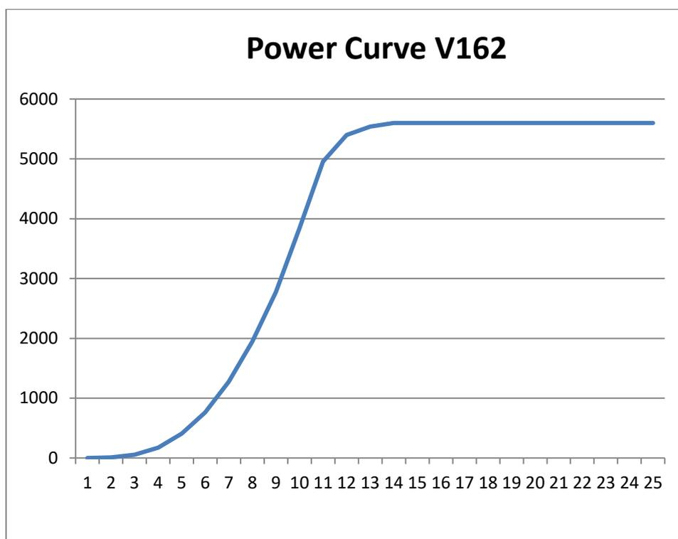
Fig. 76 – Curva di potenza Vestas V162-5.6MW
