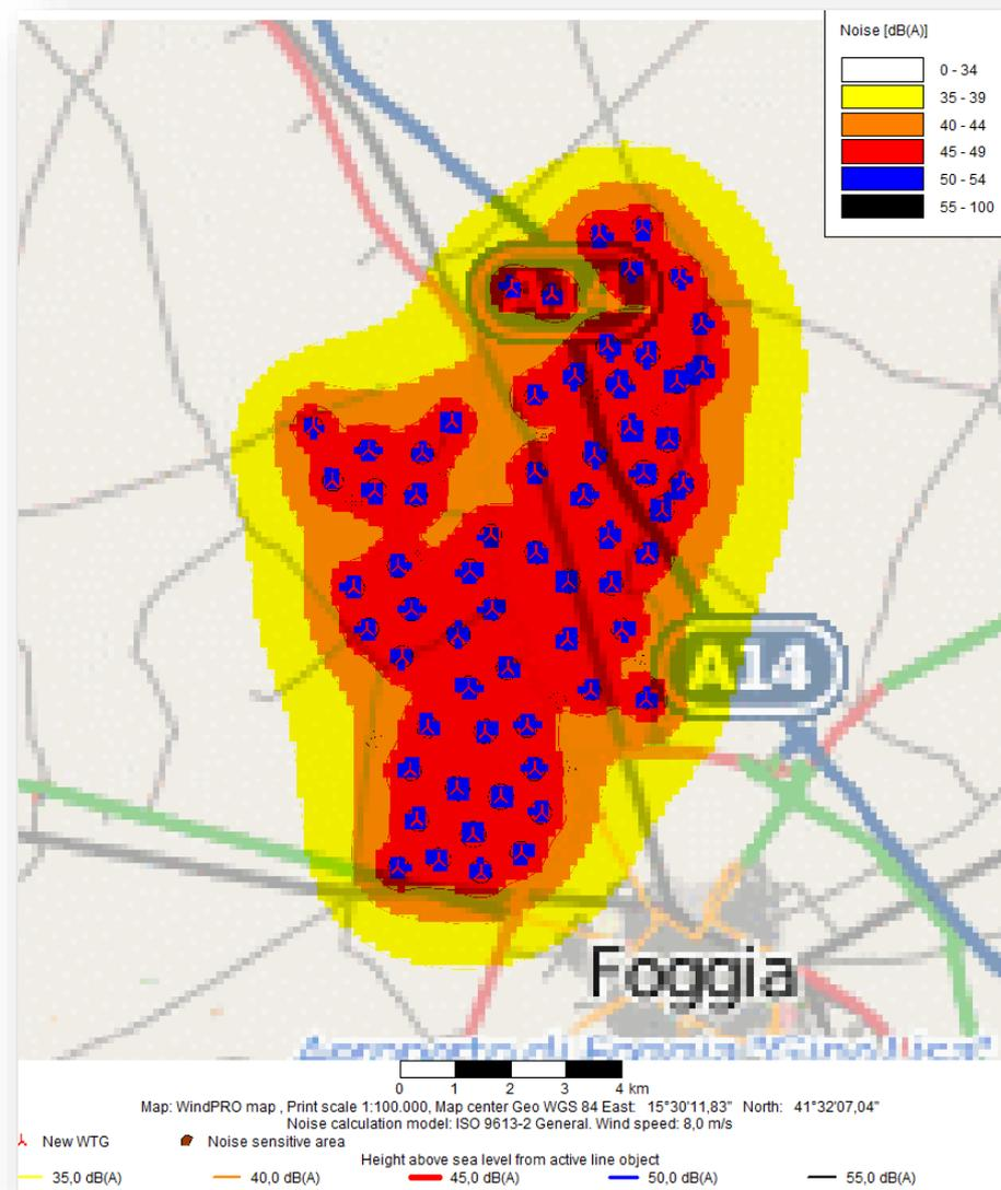
Fig. 88 - Livelli di propagazione sonora attesi con velocità del vento pari a 8m/sec – WindPro
