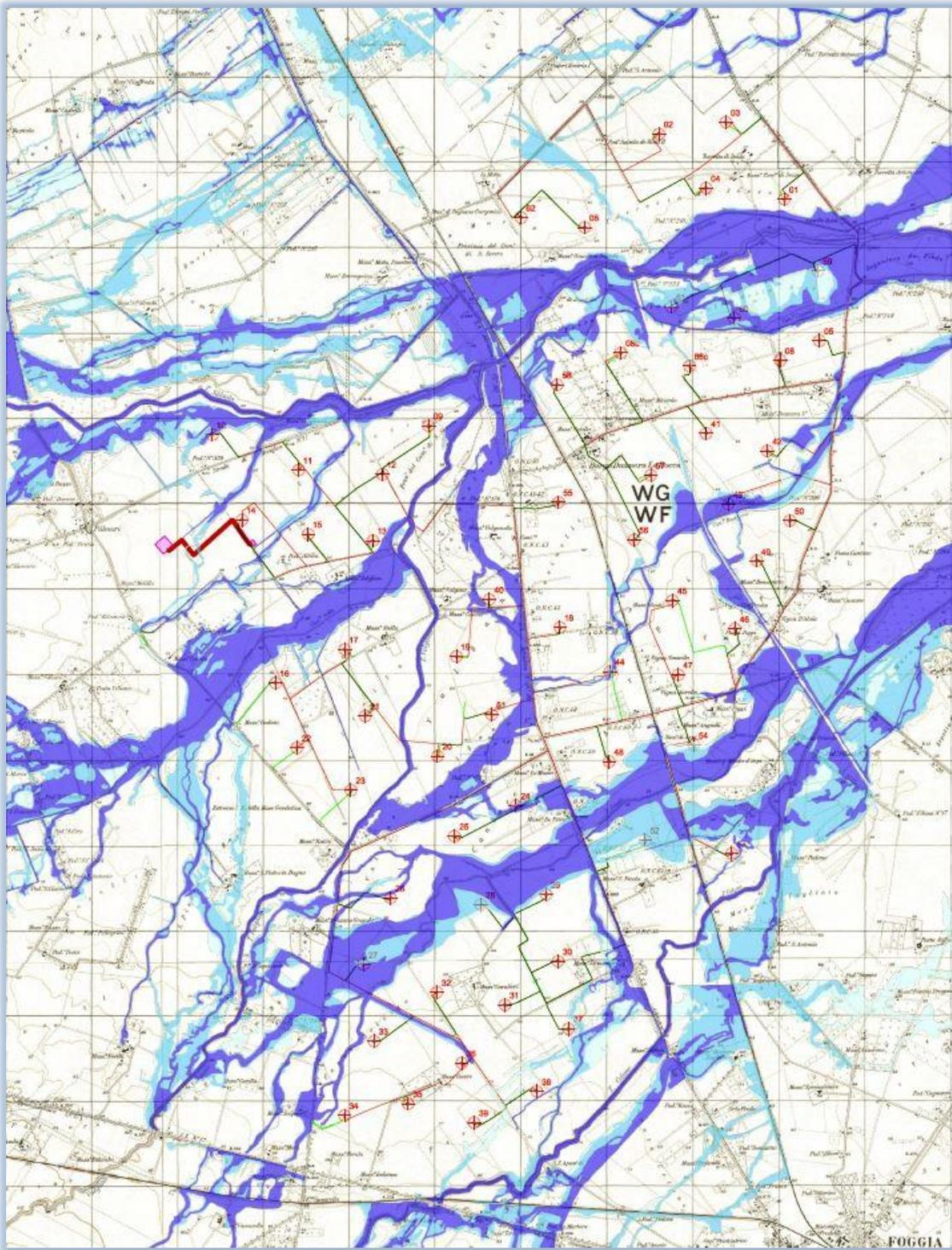
Fig. 67 –Aerogeneratori, cavidotti interni (rosso), cavidotti esterni (nero) e sottostazione(viola)con localizzazione aree a pericolosità di inondazione o pericolosità idraulica -AP (alta pericolosità), MP(media pericolosità) e BP(bassa pericolosità)
