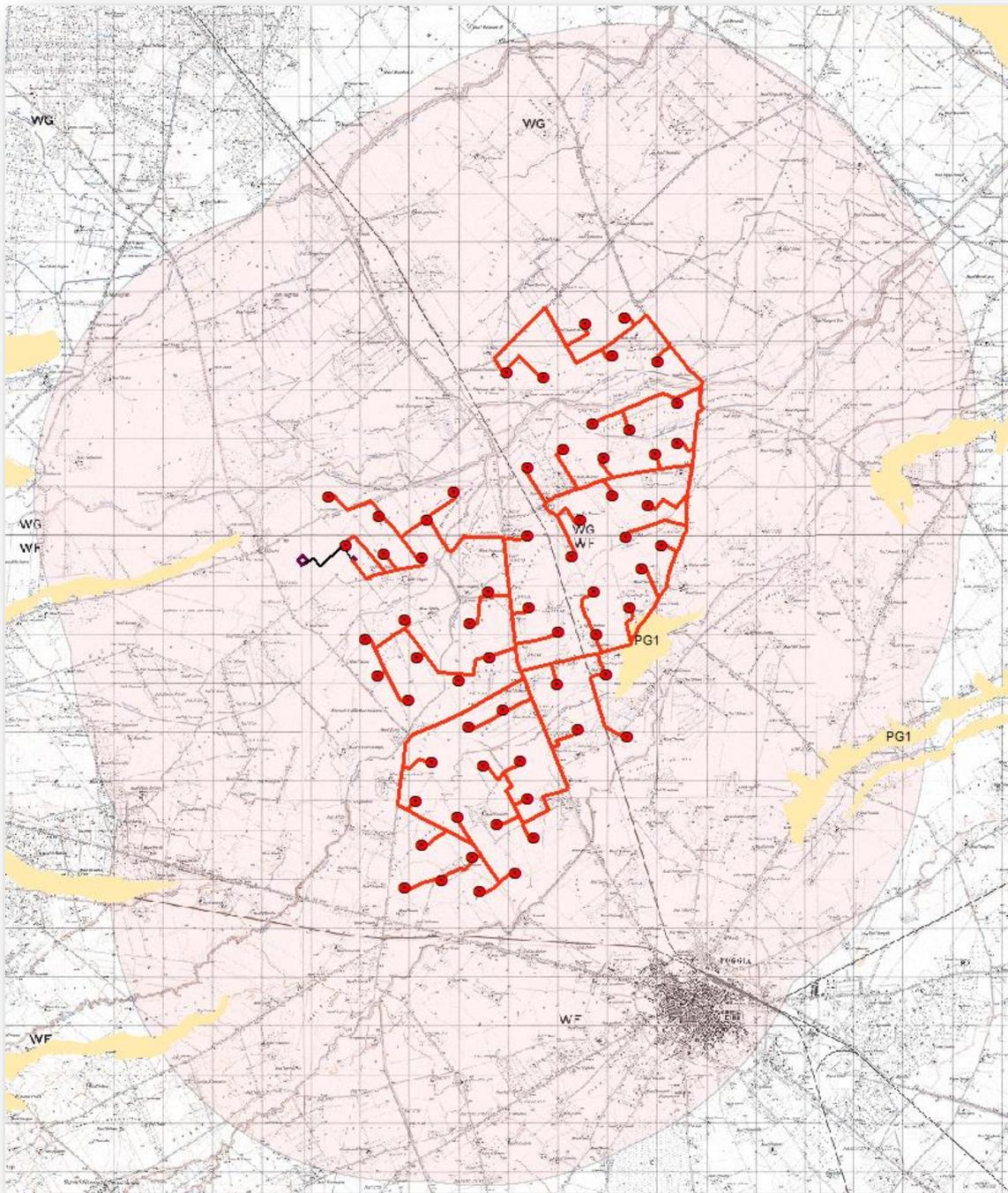
Fig. 68 –Aerogeneratori, cavidotti interni (rosso), cavidotti esterni (nero) e sottostazione(viola)con localizzazione aree a pericolosità geomorfologica – PG1 – Bassa pericolosità geomorfologica
