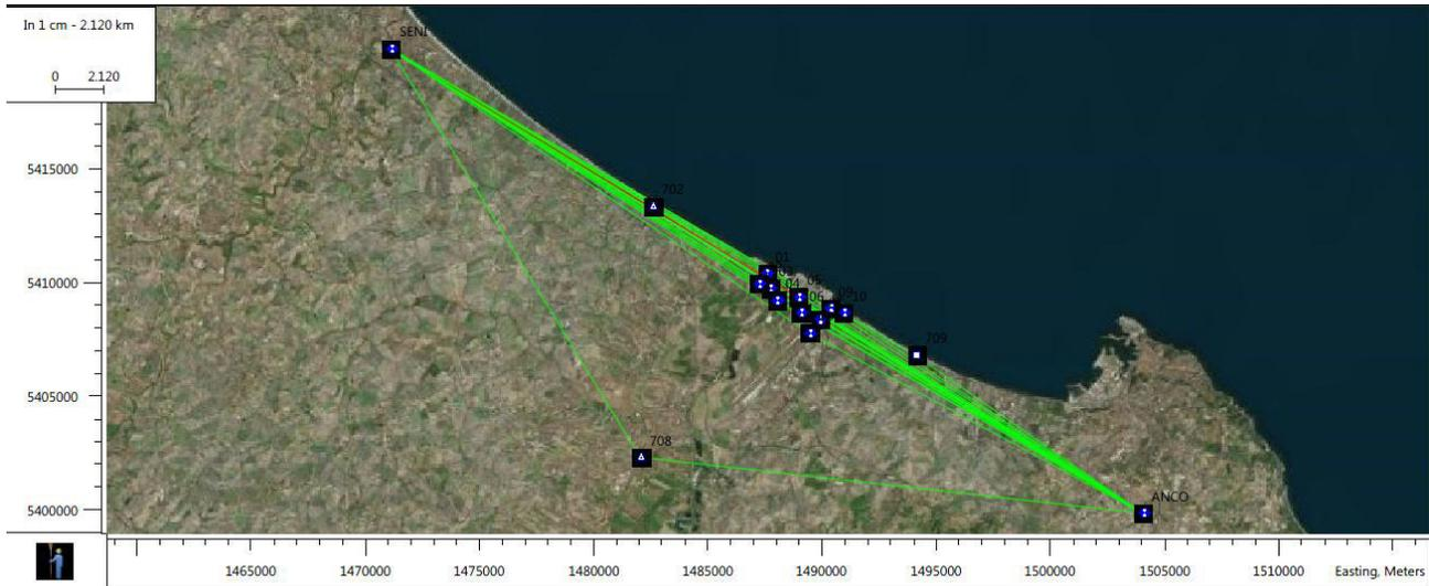
**Figura 8a** Mappa della basi di misura principali in statico comprese la basi della rete "Net Geo"
