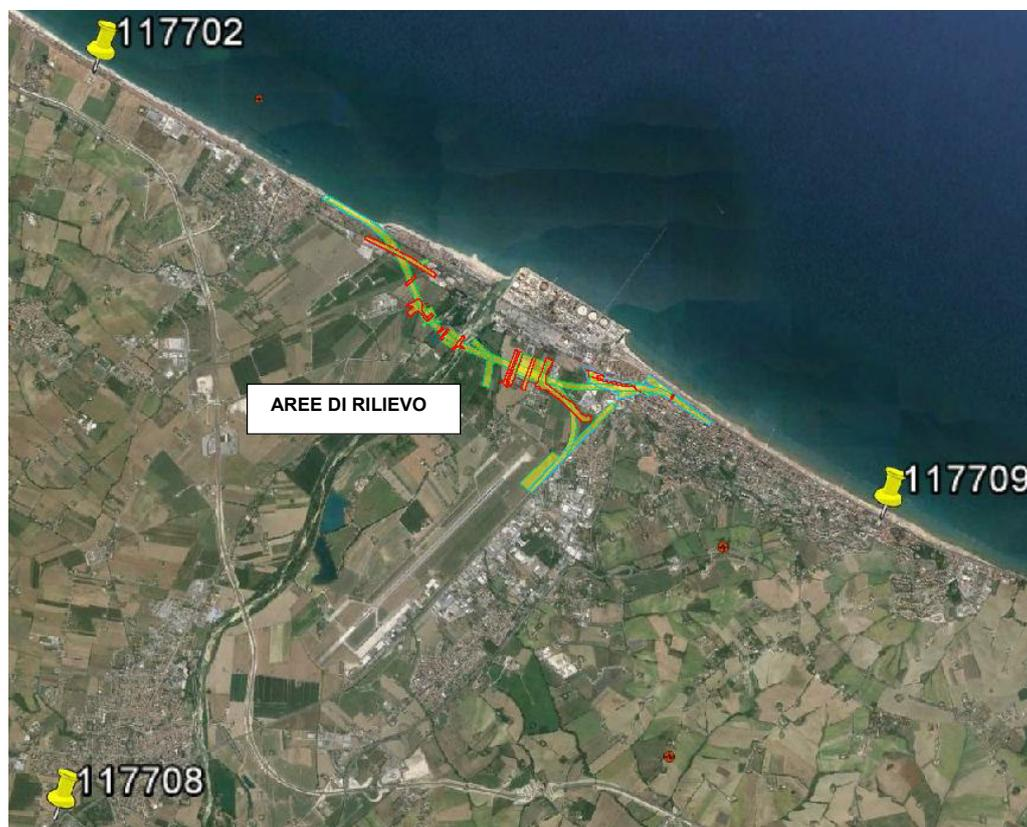
**Figura 2 Punti trigonometrici e area di rilievo**
