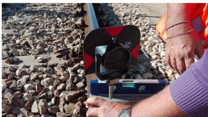
**Figura 12: Schema delle misure e staffa porta prisma utilizzata per il rilievo dei binari**
