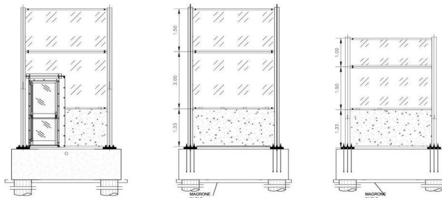
Sono previste porte di servizio ed emergenza di dimensioni 1050x2268 mm di luce netta, apribili verso l'esterno rispetto alla sede ferroviaria e previste all'interno di sistemi di aperture senza l'uso di chiavi ed un maniglione di tipo "antipanico".
