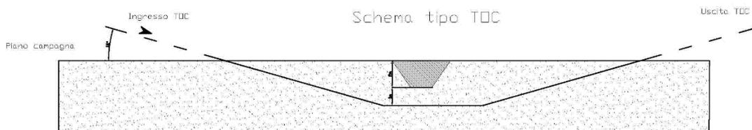
Fig.06 – Tipico di un attraversamento in TOC
