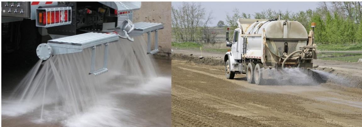
**Figura 4-1: Automezzo per la bagnatura delle piste sterrate**
