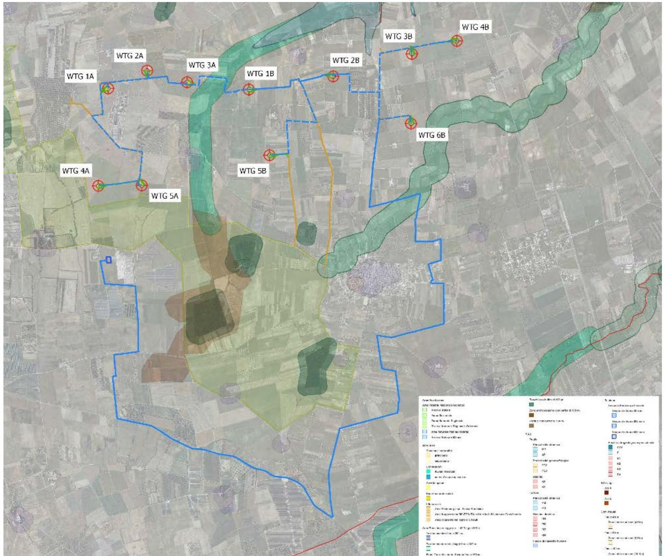
**Fig. 3-12: sovrapposizione del layout di impianto sulle Aree non Idonee, Fiumi Torrenti e Corsi d'acqua**
