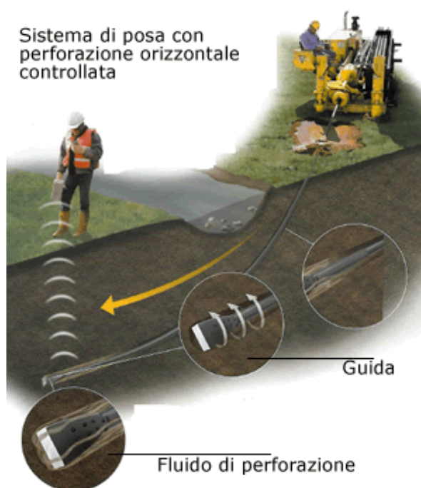
Figure 6-Sistema di trivellazione orizzontale controllata (T.O.C.).
