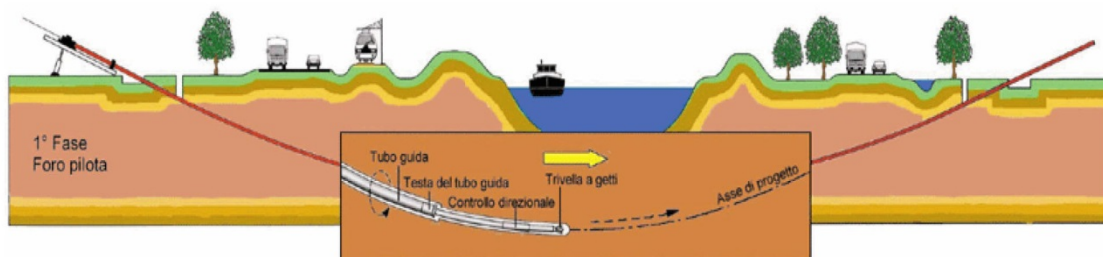
Figure 7 – Schema della fase di realizzazione del foro pilota.
