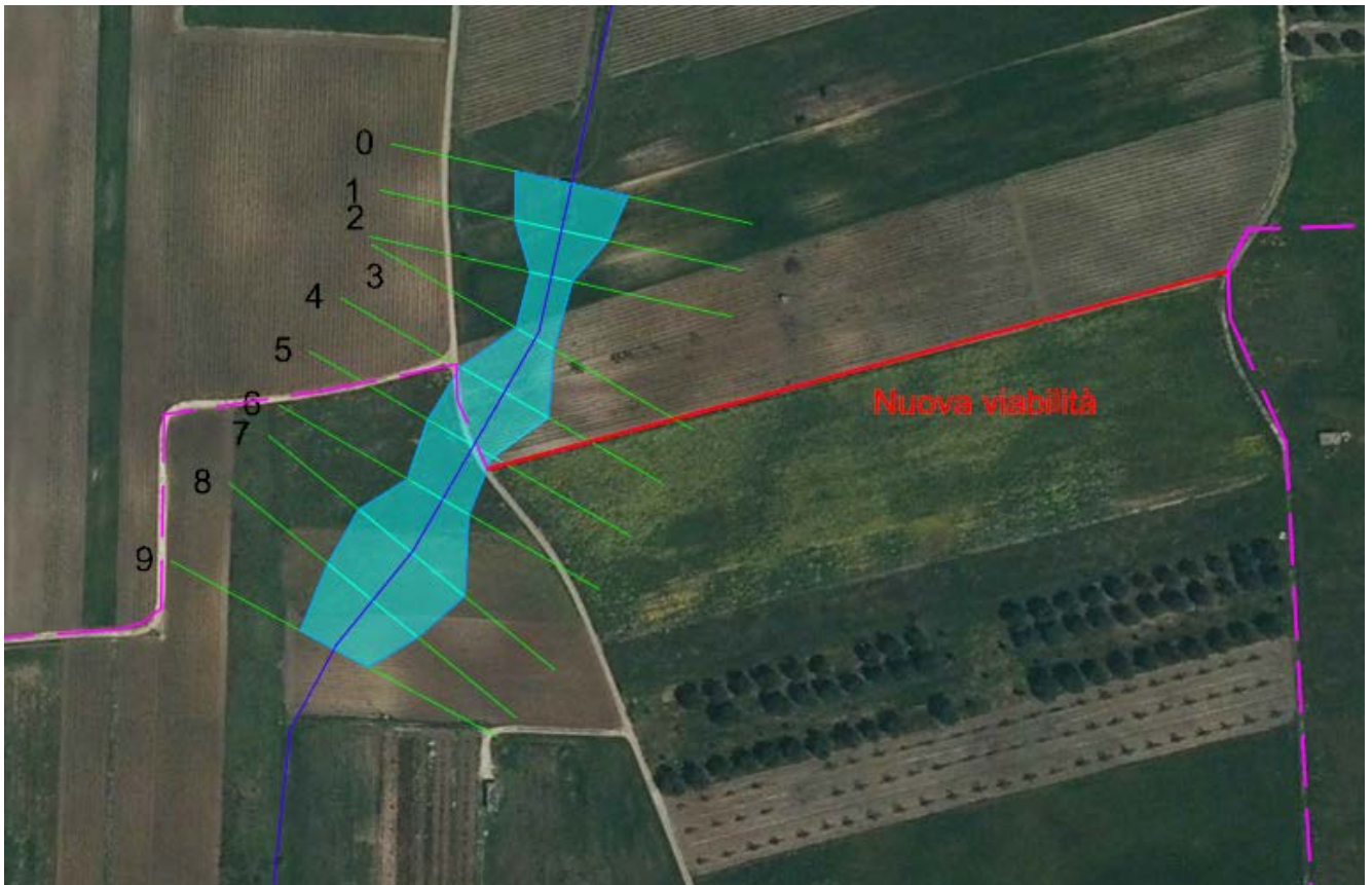
Figure 18 – Planimetria con indicazione delle aree inondabili duecentennali.
