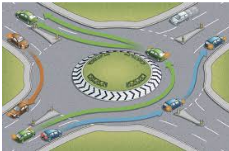
• Figura 8 – schema di funzionamento della rotatoria
