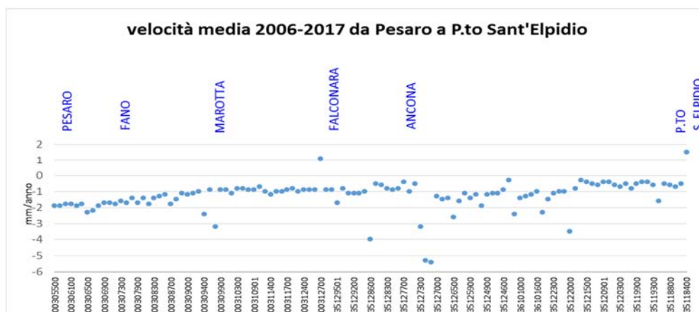
Figura A – Tratta Pesaro - Sant’Elpidio: velocità medie di subsidenza (periodo 2006-2017)
