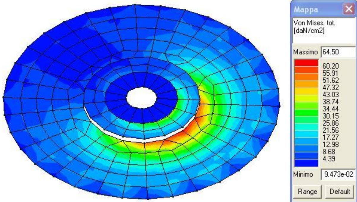
*Mappe cromatica delle tensioni totali (membrana + flessione) ottenute mediante la formulazione di Von Mises –
